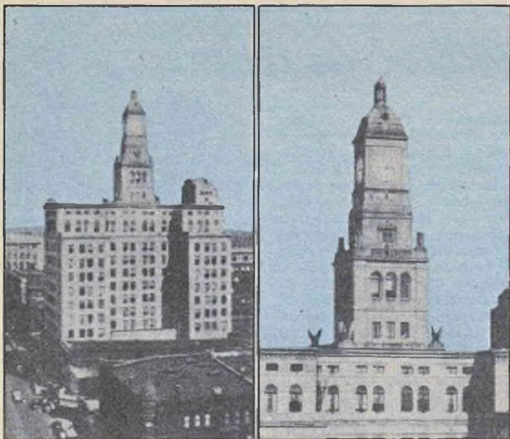
Le due foto qui presentate sono state eseguite con la stessa macchina fotografica, la prima, a sinistra, con l'obiettivo normale e completo, la seconda, invece con il solo elemento frontale convergente dell'obiettivo stesso. Notare l'allungamento di fuoco e l'effetto di telefoto che ne viene a risultare. Per la esecuzione della seconda foto è naturalmente necessario aumentare la distanza tra la pellicola o la lastra sensibile e l'obiettivo stesso, reso di focale maggiore; tale aumento di distanza si può ottenere con tubi di allungo e con soffiotti
