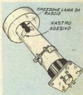
Frammenti di una lama per barba usati per correggere empiricamente un astigmatismo altrimenti difficile da eliminare.
