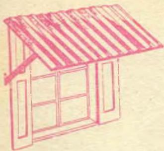
Con un rettangolo di ondulato, ed una leggera intelaiatura di legno, si può realizzare una eccellente tettoia per finestra, se di dimensioni ridotte, e per porta di ingresso se di misura maggiore. La coppia di bracci laterali di legno debbono essere previsti della lunghezza adatta perché la tettoia stessa venga a trovarsi nella inclinazione più conveniente a seconda dell'uso che si intenda farne.
