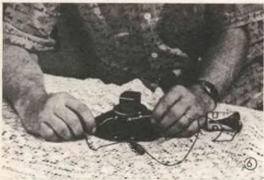
Disposizione per la esecuzione della prova per stabilire la polarità delle connessioni alla bobina mobile dell'altoparlante; si tratta di mettere il segno « + », in corrispondenza della linguetta alla quale è stato posto in contatto il filo proveniente dal polo positivo della pila da 1,5 volt, quando si è notato che il cono dell'altoparlante tendeva a muoversi verso l'esterno. Alla altra linguetta si mette ovviamente il segno « — ».
