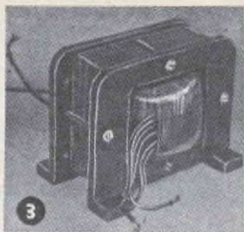
Da questo autotrasformatore acquistato, fuori uso, su di una bancarella, è stato realizzato il trasformatore alimentatore di questa fiaccola elettrica.
