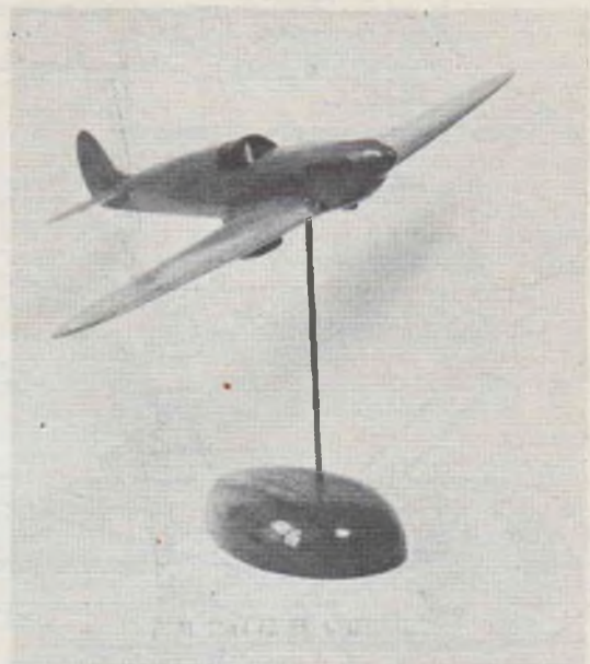
SPITFIRE - Modello in scala 1/144. Fatto in quercia e mogano e rifinito con trasparente alla nitro. - J. Ivantol - Olanda.
