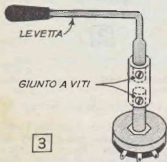
Dettaglio della levetta per le note e sistema di unione di essa all'altoparlante di comando del potenziometro R1.
