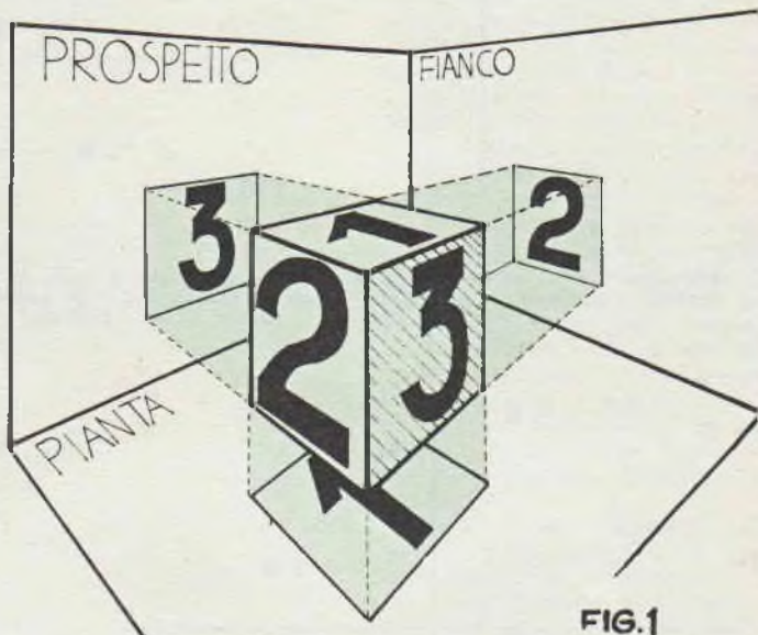
Fig. 1 - Proiezioni di un cubo su piani orizzontale, verticale e di profilo.
