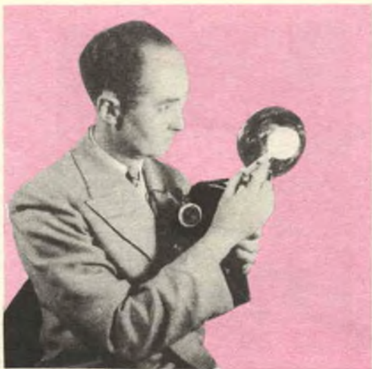
L'accessorio rappresentato in questa foto è un deflettore destinato solamente ad impedire che la luce emessa dalla lampada possa colpire direttamente il soggetto; tale accessorio è particolarmente utile per ammorbidire delle ombre troppo crude su alcuni punti sotto squadra del volto del soggetto
