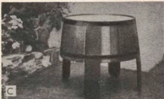
Quattro delle assi, in posizione simmetrica sono lasciate ad una lunghezza maggiore, per realizzare le zampe del tavolinetto, i cerchioni vanno rinforzati ed il ripiano può essere perfezionato con l'applicazione di un disco di formica, o di legno pregiato.
