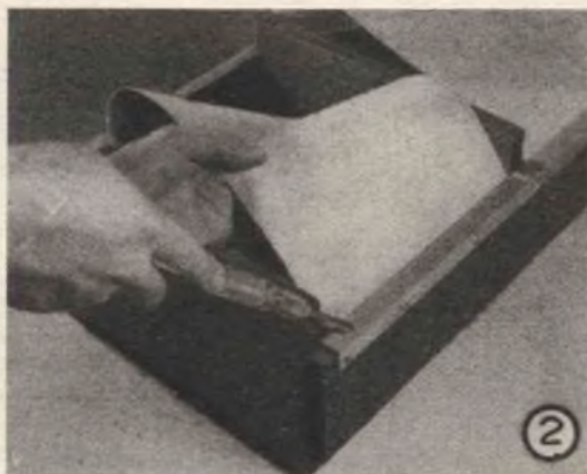
Le copertine di tela sono tese sulle lastrine interne di metallo e quindi sono ancorate con puntine da disegno, subito dopo l'ancoraggio avviene per mezzo dell'angolare fissate lungo i bordi degli elementi B.
