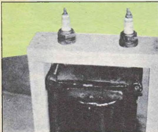
Come terminali di trasformatori a tensioni elevate. Se le candele sono ben pulite e liberate dai già citati depositi carboniosi, possono essere usate in questo modo, a patto, naturalmente che il supporto su cui esse sono fissate, sia di materiale isolante. Con questa disposizione è possibile fare sopportare alle candele, una tensione dell'ordine dei 20.000 volt, senza che abbia a verificarsi una scarica troppo forte.
