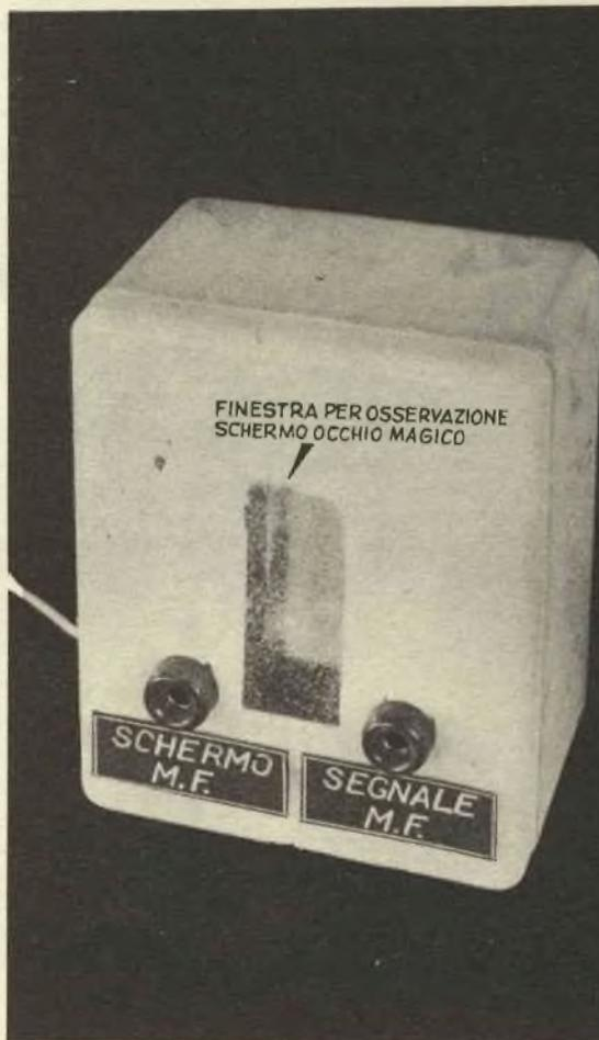
L'apparecchio completo e pronto per l'impiego; nelle due boccole si inserisce la coppia di banane munite ciascuna di un conduttore terminante con una pinzetta a coccodrillo
