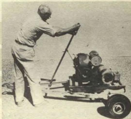
alla estremità opposta di essere afferrata e tirata con forza dall'operatore della macchina che si intende avviare. La cordicella dello strappo, opportunamente allungata, viene fissata in un punto conveniente della leva, in modo che il punto di applicazione delle forze sia favorevole, per un minimo di fatica, in proporzione ad un massimo di rendimento.
