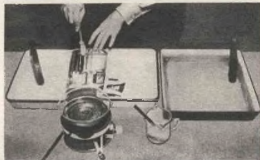
Lo sviluppatore normale diluito nel doppio del proprio quantitativo di acqua, e portato ad una temperatura elevata a mezzo di apposito fornellino, serve per trasferirlo, con il tampone sulle stampe da rafforzare.
