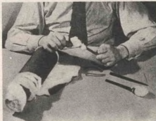
Il tampone deve essere formato volta per volta, avvolgendo su delle aste di vetro un batuffolo di cotone idrofilo, fermato con dei semplici elastici.
