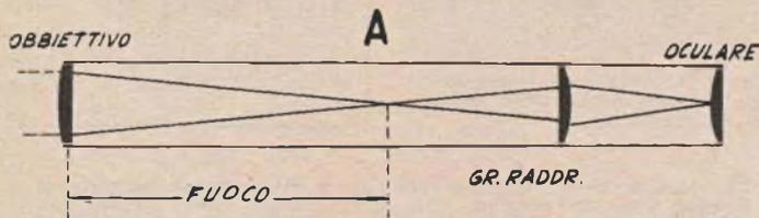
va precisamente di una lente da occhiali per presbiti, ossia divergente, della potenza di 3,3 diottrie, pari ad una distanza focale di 30 centimetri. Oltre a tale lente mi ero trovato in possesso di quattro lenti uguali per contafili, del diametro ciascuna, di mm. 15 e della lunghezza focale di cm. 3, naturalmente convergenti.
