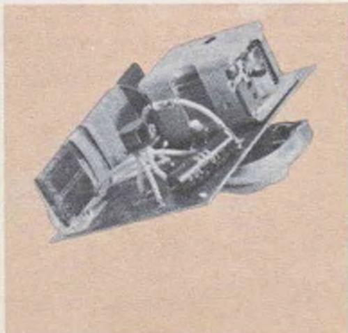
ponente continua è raccolta sul lato «freddo» della bobina L2, filtrata da C2, allo scopo che divenga «vera» corrente continua ed inviata alla resistenza di polarizzazione R2 ed al collettore, attraverso la cuffia a media impedenza, da 500 ohm.
