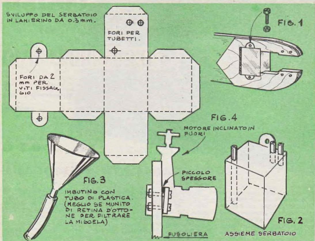
indifferentemente, serve per l'introduzione del carburante, che viene effettuata mediante un imbutino dotato di filtro, e prolungato con un tubetto di plastica (fig. 3); mentre l'altro permette il deflusso dell'aria. L'uso dell'imbutino si può evitare usando una bottiglietta di plastica, che funziona da pompa, collegata al condotto di rifornimento a mezzo del solito tubetto di plastica.
