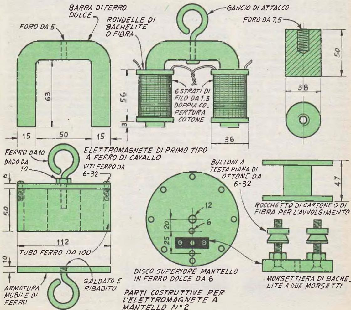
to più perfetto possibile; per questo occorre che anche la superficie del disco, rivolta verso il bordo del mantello, sia reso perfettamente regolare; prima con una accurata limatura.
