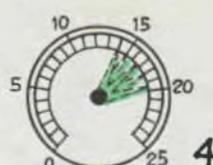
*USURA NELLE GUIDE DELLE VALVOLE, L'INDICE VIBRA*
