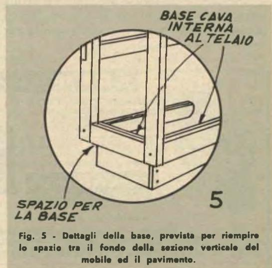
Fig. 5 - Dettagli della base, prevista per riempire lo spazio tra il fondo della sezione verticale del mobile ed il pavimento.
