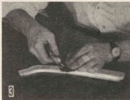
Ancoraggio della cerniera di pelle con punti di cucitrice e con poche gocce di adesivo flessibile universale.
