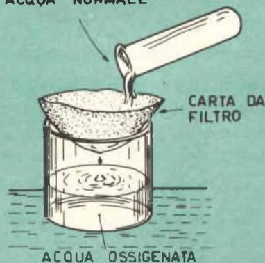
Per la fabbricazione dell'acqua ossigenata, è necessario ottenere il perossido di bario (disegno in alto), il quale deve essere mescolato all'acido solforico (disegno in mezzo). Insieme all'acqua ossigenata si otterrà anche un corpo solido polverulento che si eliminerà mediante filtrazione (disegno qui sopra).
