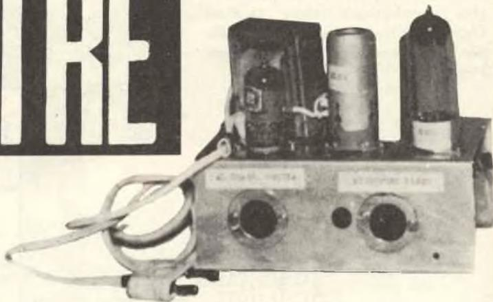
Per coloro che si sentono ancora « legati » alle valvole e desiderano progetti di apparecchiature sperimentali, atte, cioè a subire delle modifiche nella fase di collaudo, tese ad un ulteriore perfezionamento dell'apparecchio stesso, presentiamo questa volta l'AMPLITRÈ, un semplice amplificatore di B.F. a tre stadi più raddrizzatrice, dal circuito veramente elementare e che può essere utilizzato specialmente per l'amplificazione della parola o in una valigetta fonografica amplificata.
