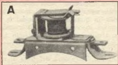
Interruttore di minima, come si presenta nelle condizioni originali, quasi sempre coperto da una calotta
