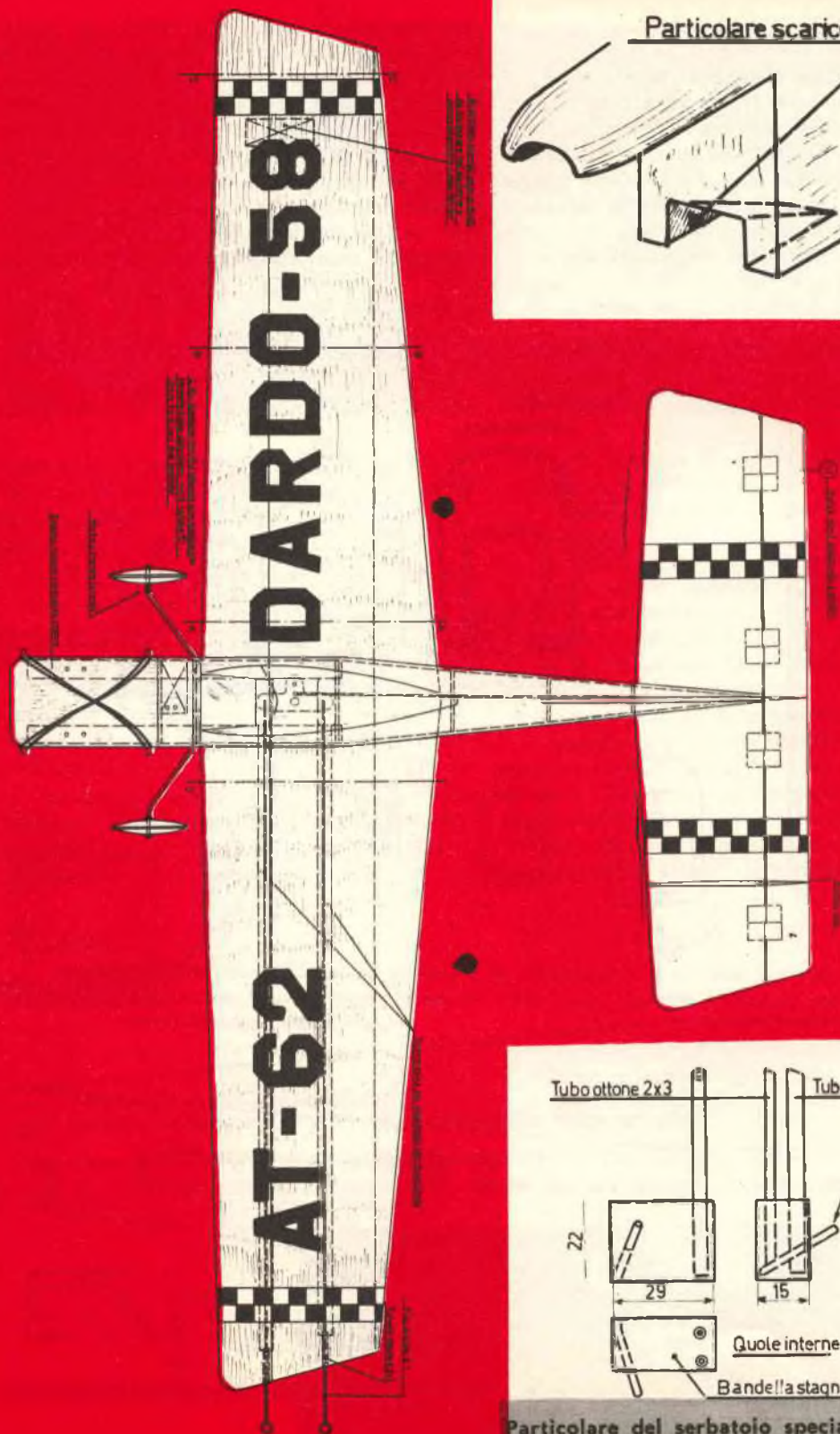
Particolare del serbatoio speciale Team Racing della capacit  di 10 cm. 3
