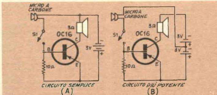
mercato del materiale americano residuo, munito della custodia con impugnatura con pulsante da premere per mettere in funzione il complesso. Come nota, la uscita dell'amplificatore può essere inviata direttamente all'altoparlante senza alcun intermedio di trasformatori; potrà usare un altoparlante da 3 ohm, sebbene uno di impedenza maggiore di bobina mobile, assicurerà una maggiore utiliz-
