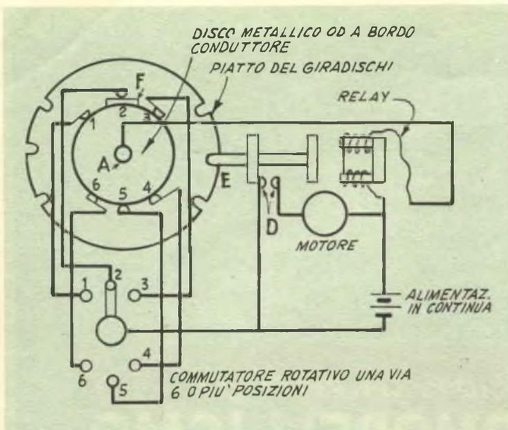
D: Coppia di contatti aggiunti al relay od al solenoide, in modo che si chiudano quando l'ancoretta dello stesso, vada nella posizione di lavoro, attratta dall'elettromagnete e che si aprano quando lo stesso sia diseccitato.
