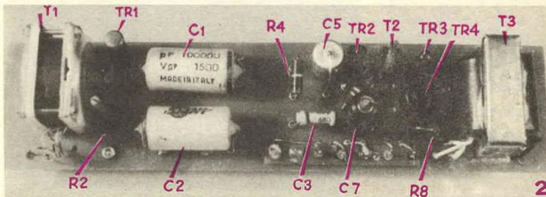
Telaino con il circuito. La basetta è in cartone bachelizzato e le parti sono inflatte e saldate in piccole rivette ribattute
