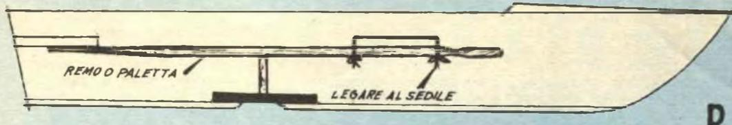
Quando la imbarcazione non è pontata e quando nel punto in cui si verifica la falla mancano punti di appoggio per la inserzione dei listelli di pressione, questo, può essere un sistema per la produzione della pressione stessa: come si vede, si utilizza un remo le cui estremità sono ancorate a loro volta in punti opportuni della imbarcazione; contro tale elemento poi si incastra uno o più listelli per la produzione della pressione sul compensato o sul cuscinetto, usati per tamponare la falla
