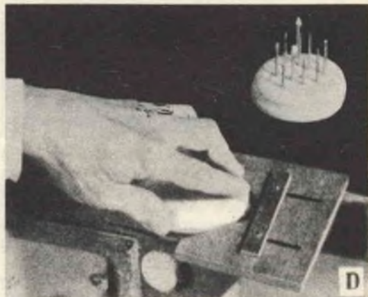
Formatura di medianature lungo un bordo non diritto: si utilizza la parte con la tacca a V della guida, in modo da trattenere il lavoro nella posizione regolare.
