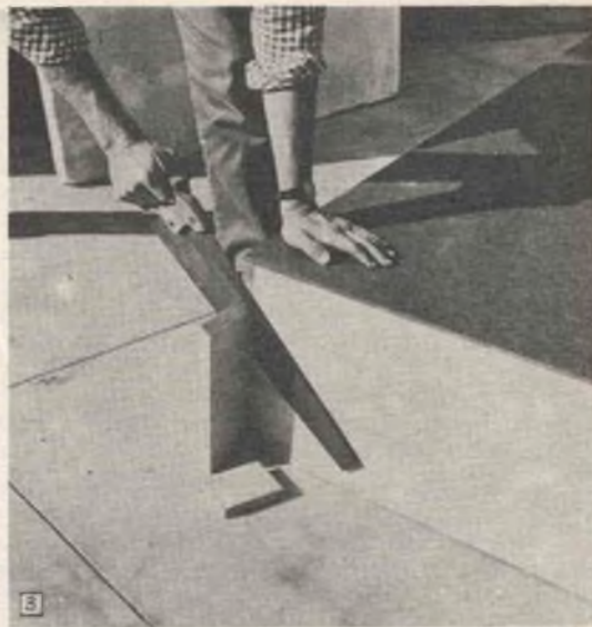
Convien tagliare a misura le assi delle fiancate, nella parte di poppa, dopo che sia stato messo a dimora il fondo dello scafo e la poppa di esso
