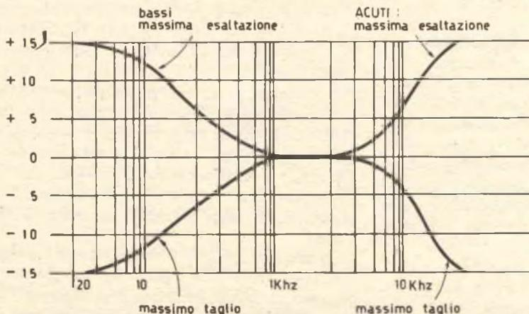
FIG. 4: Diagramma del controllo di tono. In esso sono riportate le caratteristiche di risposta in frequenza del preamplificatore.
