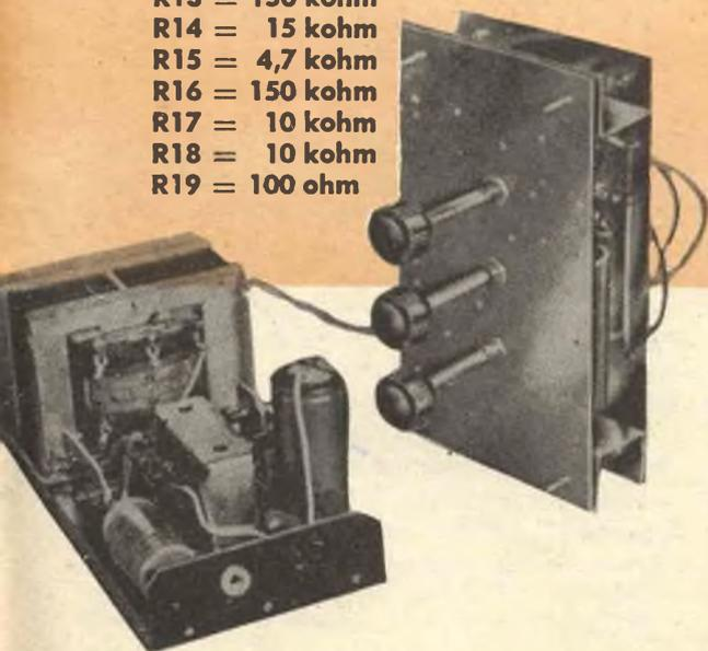
Per la realizzazione si deve ricorrere a due lastre di laminato plastico tagliate e distanziate secondo i disegni.
