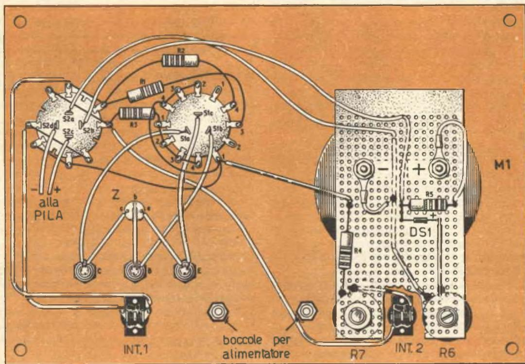
FIG. 1: Circuito teorico del transistor tester. FIG. 2: Circuito pratico di questo utile strumento.
