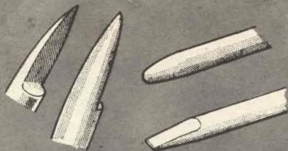
Alcuni tipi di punte di rame da utilizzare per incidere la lastra di plastica.
