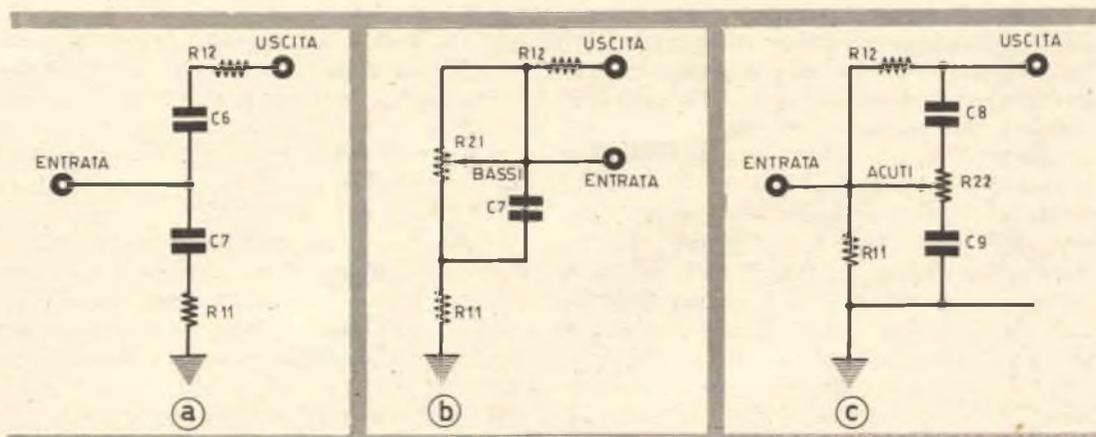
**FIG. 3:** Circuito di controllo del tono (prima figura a sinistra). Il circuito a bassa frequenza per il basso massimo (frequenza minima) è illustrato al centro. A destra si presenta invece il circuito alle alte frequenze.
