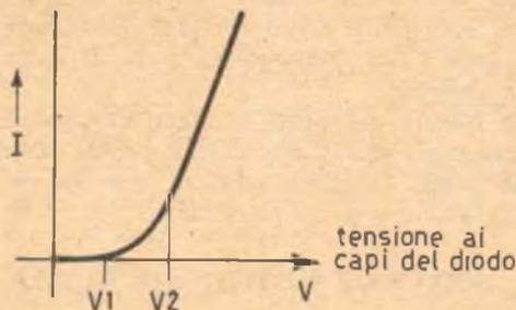
**FIG. 3: Andamento della corrente in funzione della tensione applicata al diodo DS 1.**
