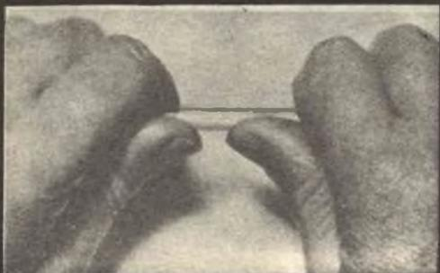
Tenete la sbarretta con la scalfittura lontana da voi, tirate e piegate leggermente in modo da provocare la rottura.
