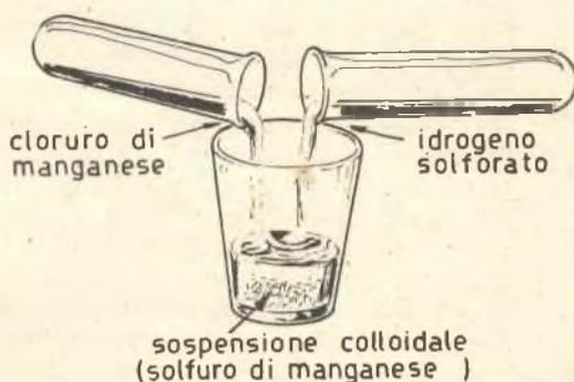
Carbonato di manganese ed acido cloridrico formeranno il cloruro di manganese, il quale, a sua volta unito ad idrogeno solforato, darà luogo ad una sospensione colloidale (solfuro di manganese).
