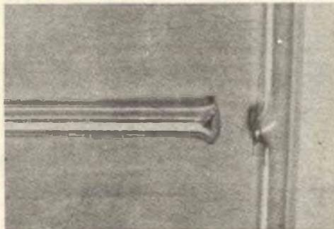
Due pezzi di tubo, resi morbidi alla fiamma, possono venir sovrapposti e saldati, in modo da ottenere un giunto a T.
