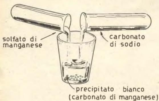
In alto. Solfato di manganese e soda caustica diluite danno luogo ad un precipitato bruno. Qui sopra. Lo stesso solfato di manganese, ma unito a carbonato di sodio, formerà un precipitato bianco.
