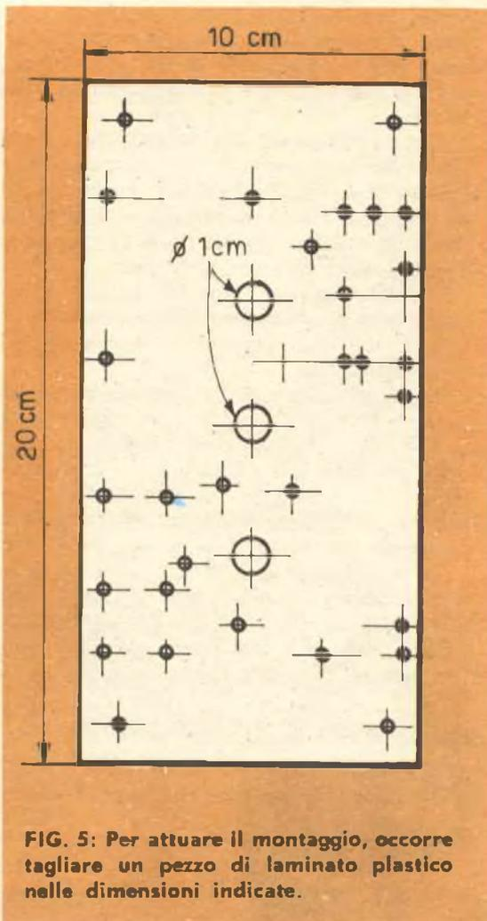
FIG. 5: Per attuare il montaggio, occorre tagliare un pezzo di laminato plastico nelle dimensioni indicate.
