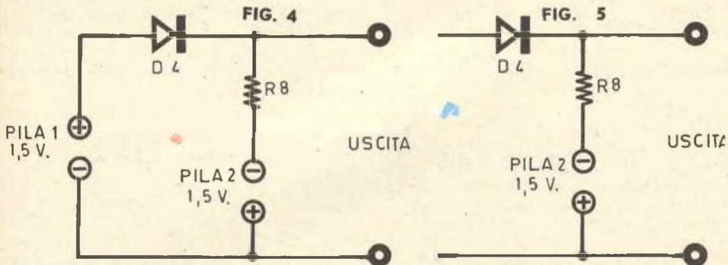
batteria PILA 2 attraverso i diodi e le resistenze. I diodi provocano una caduta di tensione di qualche millivolt poiché la sua resistenza diretta è molto bassa rispetto a quella delle resistenze: per questo si può ricavare ai capi una delle due resistenze R7 e R8 l'intera tensione dei 3 volt circa: all'uscita quindi abbiamo 1,5 volt, positivi, dovuti alla differenza tra i 3 volt su una delle due resistenze e i - 1,5 volt della PILA 2.
