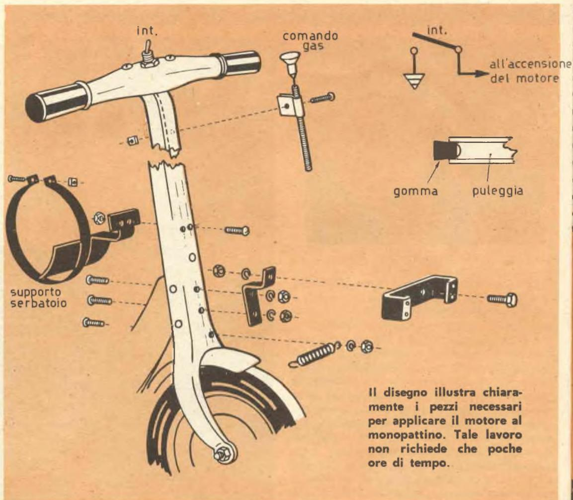
un negozio di articoli di plastica, chiedendo espressamente un tubo per prodotti chimici, del tipo flessibile. Il serbatoio deve risultare in posizione leggermente superiore a quella del carburatore. Il supporto a « Z » regge il motore con un'angolazione per cui si potrebbe tracciare una linea immaginaria tra l'asse del motore e quello della ruota anteriore del monopattino.
