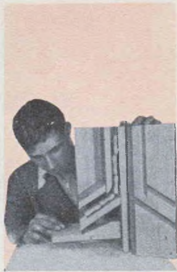
Una delle pareti laterali è stata tolta per mostrare il canale che contiene i biscotti e che in basso presenta la «valvola» dal cane con una zampa
