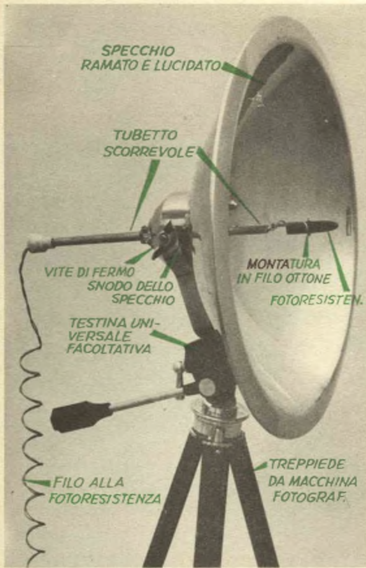
Il complesso del cercatore vero e proprio, con lo specchio parabolico, nel cui fuoco si trova la fotoresistenza e con il sistema di brandeggio, per l'orientamento del complesso stesso, in qualsiasi direzione. Notare anche il gruppo di supporto della fotoresistenza ed il tubetto affiancato che serve da mirino.
