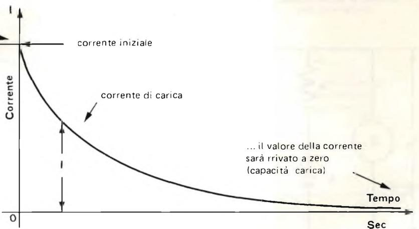
Come si vede, la corrente appare transitoriamente durante la carica, annullandosi a carica avvenuta, mentre la tensione permane ai capi del condensatore carico.
