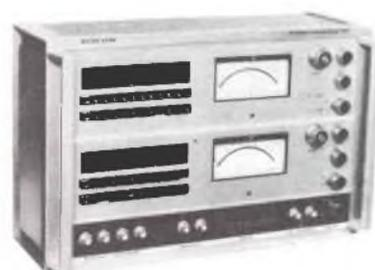
gente a frequenza audio ed anche un operatore non specializzato può ottenere una discriminazione dello 0,01% della lettura a fondo scala, per ciascuna delle otto gamme di funzionamento disponibili. Il campo totale di capacità, di conduttanza, di resistenza e di induttanza va da 2 milliohm a 50.000 megaohm e l'accuratezza dello 0,1% si ottiene completamente, da 1 picofarad a 10 microfarad, da 10 ohm a 100 megaohm, e da 1 millihenry a 10 kilohenry.
