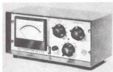
Il modello Unitemp è simile come aspetto al Multitemp; è studiato per l'uso con termocoppie nickel-cromo/nickel-alluminio, ferro/costantana, e rame/costantana, e non comprende la compensazione per le variazioni al punto freddo. La gamma di temperature della scala dello strumento può essere usata come una scala in millivolt, e può quindi servire anche per altri
