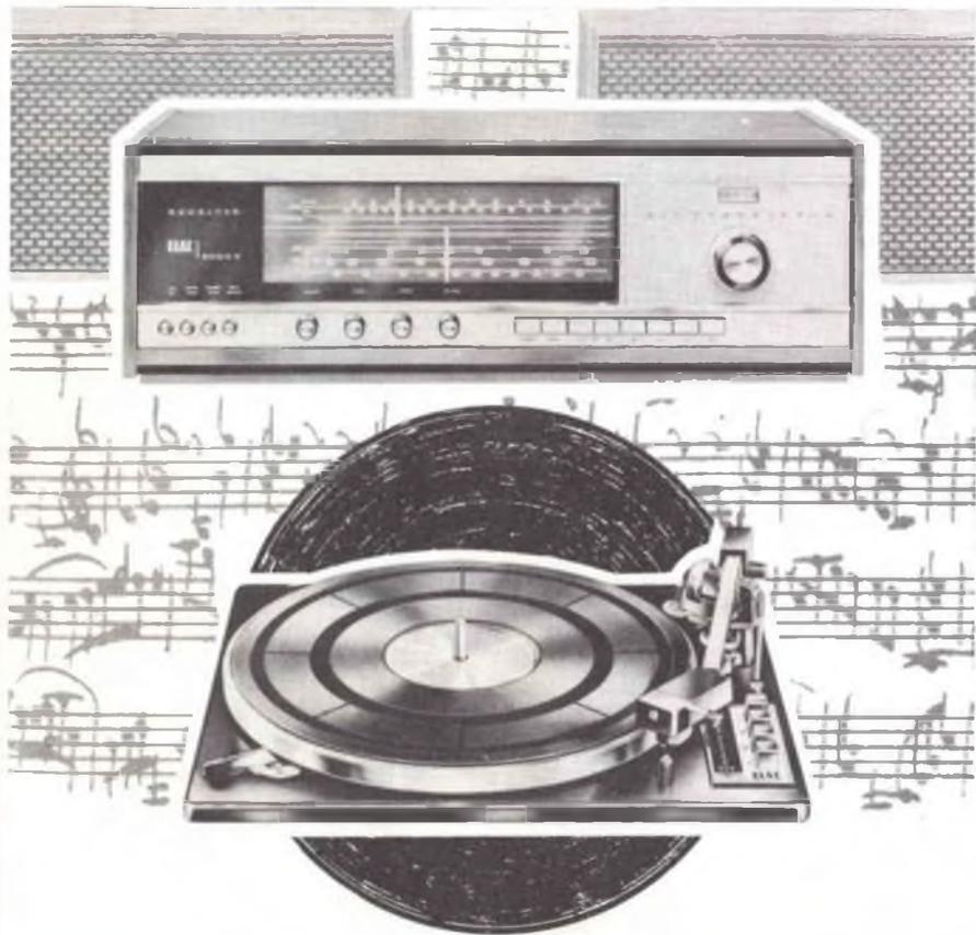
Complesso sintonizzatore-amplificatore transistorizzato per la riproduzione mono e stereofonica ad alta fedeltà. La sezione « sintonizzatore » con comandi separati per le gamme FM-AM, copre le bande:  $87,3 \div 104$  MHz —  $59 \div 7,4$  MHz —  $510 \div 164$  MHz —  $145 \div 360$  KHz utilizzando 15 transistor e 15 diodi. Essendo inclusa la gamma delle onde lunghe, il sintonizzatore è pronto per essere collegato ai canali della FILODIFFUSIONE in HI-FI.
