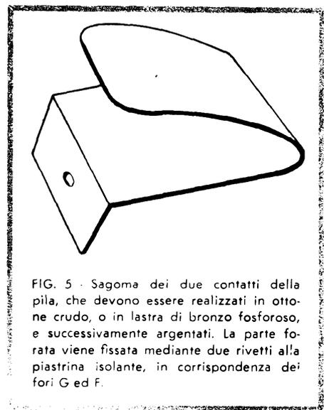
FIG. 5 - Sagoma dei due contatti della pila, che devono essere realizzati in ottone crudo, o in lastra di bronzo fosforoso, e successivamente argentati. La parte forata viene fissata mediante due rivetti alla piastrina isolante, in corrispondenza dei fori G ed F.
