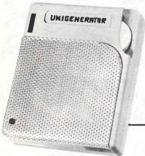
Aspetto del generatore racchiuso nel mobilino previsto. Si noti la manopola che controlla R2-S1, sporgente dall'incastro in origine effettuato per il controllo di volume. La fessura sulla sinistra, in origine appartenuta al controllo della sintonia è stata otturata con dello stucco per carrozzerie.
