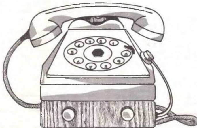
**Fig. 1** - Principio di funzionamento del dispositivo descritto. Dalla parte frontale sporgono le due manopole per l'accensione e per la regolazione del volume. L'altoparlante è invece rivolto verso il retro, per cui non risulta visibile.
