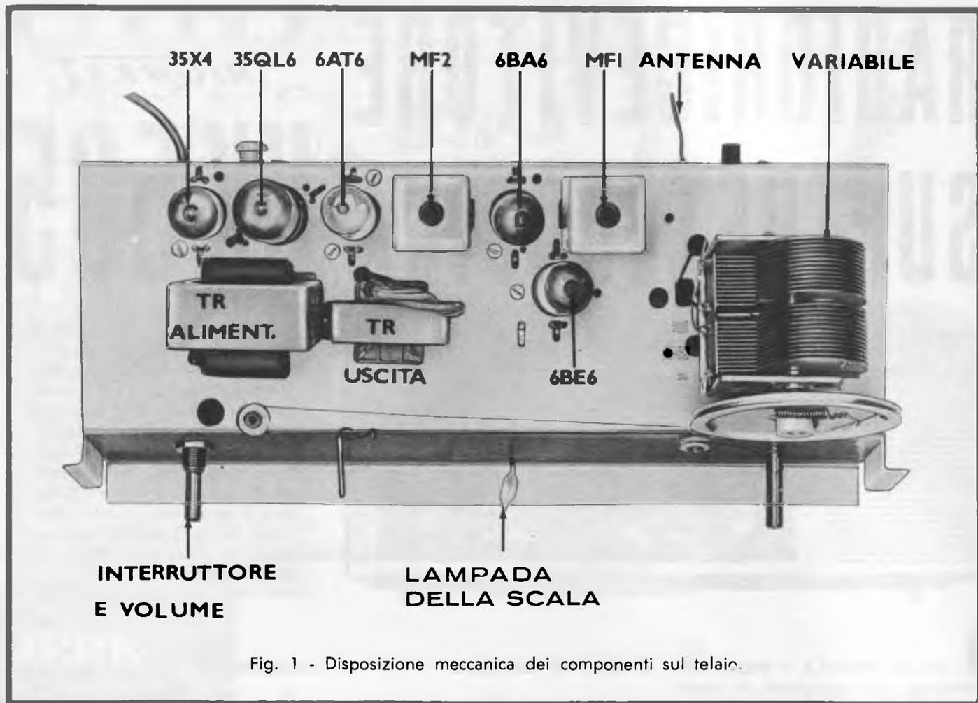
Fig. 1 - Disposizione meccanica dei componenti sul telaio.
