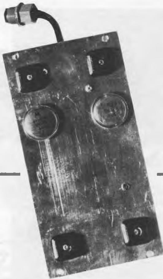
I transistor di potenza sono montati sul fondo dell'amplificatore, come si scorge da questa figura.
