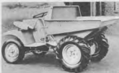
La macchina è una versione più grande e più potente dei "dumper" da 770 e da 1155 Kg costruiti dalla Compagnia, mantiene la costruzione con trasmissione tutta in linea (né cinghie né catene) e le caratteristiche di facile maneggio dei modelli minori. La cassa può essere ribaltata manualmente o con comando idraulico; in alternativa può essere fornita una cassa sollevabile mediante gru.
