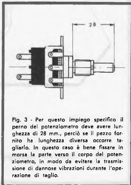
Fig. 3 - Per questo impiego specifico il perno del potenziometro deve avere lunghezza di 28 mm., perciò se il pezzo fornito ha lunghezza diversa occorre tagliarlo. In questo caso è bene fissare in morsa la parte verso il corpo del potenziometro, in modo da evitare la trasmissione di dannose vibrazioni durante l'operazione di taglio.
