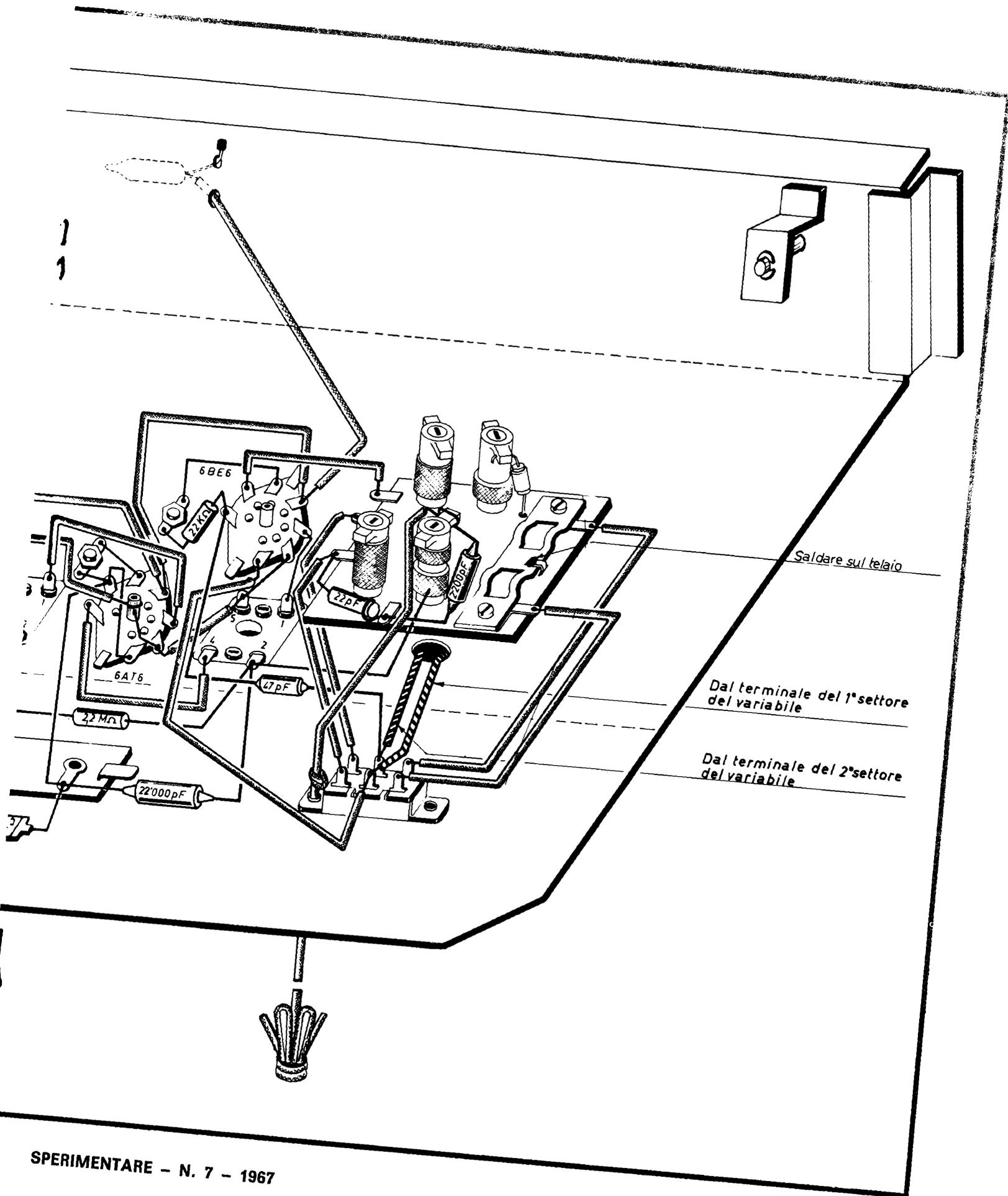
467 kHz all'antenna del radiorecettore, il condensatore di sintonia deve essere tutto aperto, e ruotare quindi con un cacciavite con lama non metallica i nuclei delle due medie frequenze fino ad ottenere il massimo segnale di uscita (con potenziometro al massimo volume). Con questa semplice operazione si allinea l'amplificatore MF costituito dalla valvola 6BA6 e relativi trasformatori accordati.
