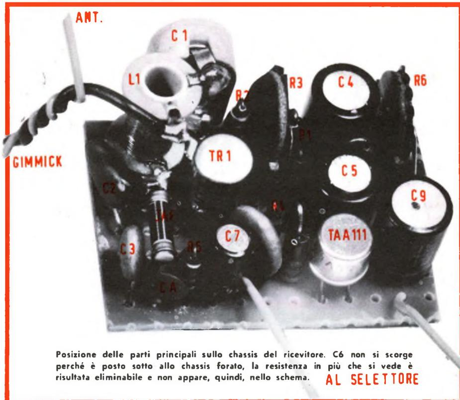
Posizione delle parti principali sullo chassis del ricevitore. C6 non si scorge perché è posto sotto allo chassis forato, la resistenza in più che si vede è risultata eliminabile e non appare, quindi, nello schema. **AL SELETORE**
