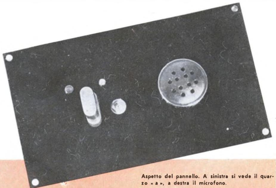
Aspetto del pannello. A sinistra si vede il quarzo «a», a destra il microfono.
