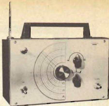
**Convertitore supereterodina a 12 gamme e due transistor; copertura continua da 1,5 a 7,7 m; uscita per AM/FM a 10,7 MHz. La costruzione di questo convertitore per quanto possa sembrare semplice è consigliabile solo a coloro che hanno un po' di pratica con le VHF e possiedono un'attrezzatura adeguata.**
