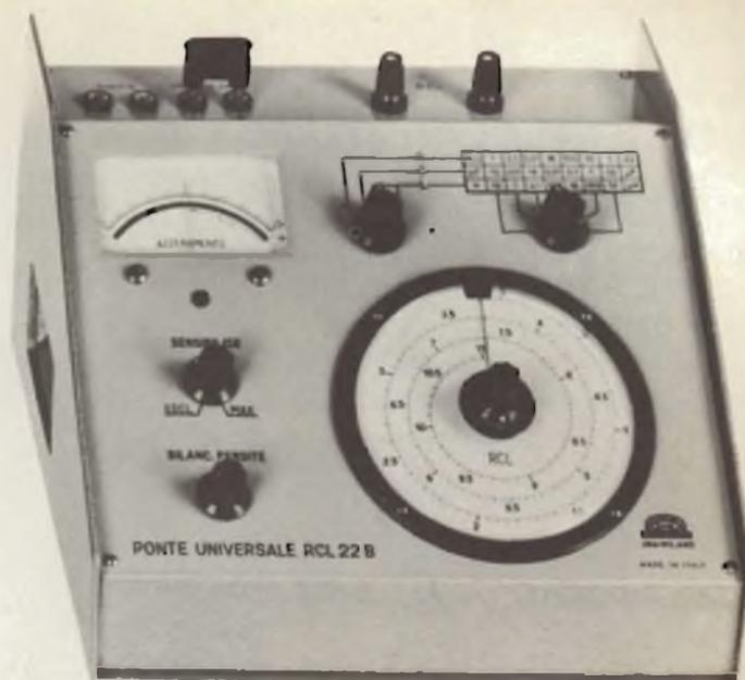
Il Ponte RCL 22 B riunisce in un unico complesso di dimensioni limitate, sia i comandi del ponte propriamente detti, adatti per misure di resistenze, capacità e induttanze, sia le varie parti ad essi asservite e cioè: un generatore di tensione continua, un generatore di tensione a 1000 Hz, un galvanometro indicatore di zero ed un amplificatore selettivo.
