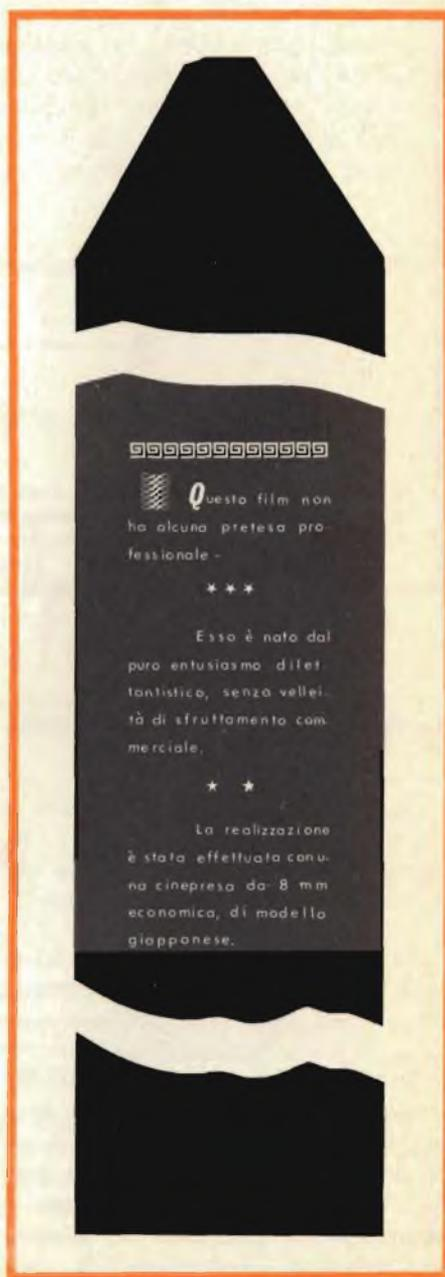
Fig. 4 - Esempio di una lunga nota introduttiva, che può essere ripresa col metodo descritto alla figura 3. In alto si nota la forma che viene data dalla striscia per l'agganciamento al rullo superiore. Il movimento deve essere eseguito con una velocità opportunamente dosata.
