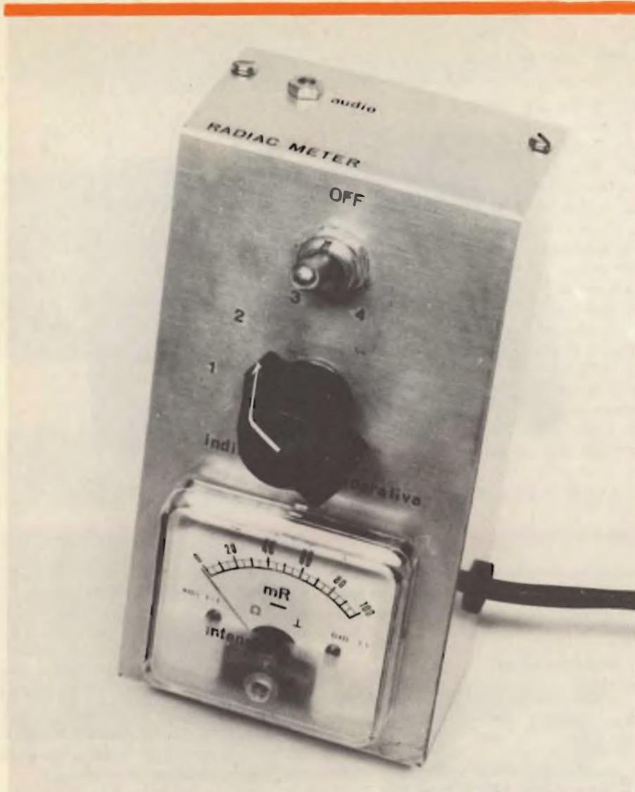
Aspetto del contatore pronto all'uso. La scala dell'indicatore, reca la scritta « mR » (milliRoentgen) che è puramente indicativa, non essendo la scala medesima calibrata per una indicazione assoluta, ma comparativa.
