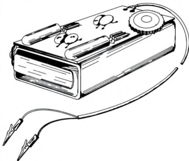
Fig. 3 - Aspetto dell'apparecchio montato, e completo del cavetto di prova. L'involucro che lo contiene deve essere tale da consentire l'alloggiamento sia del circuito, sia della batteria di alimentazione, avente le medesime misure di ingombro.
