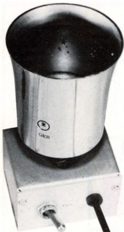
La lavatrice che vi presentiamo, non ha certo le possibilità dei modelli industriali che assorbono numerosi kilowatt dalla rete ed impiegano grosse valvole trasmettenti negli oscillatori. Funziona però sull'identico principio di quelle macchine ed è assai utile per la pulizia di minuscoli congegni appartenenti a strumenti ottici o meccanici di precisione.
