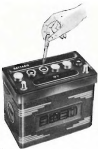
Fig. 1 - Un inchiostro simpatico ad acqua acidulata lo si prepara facilmente prelevando alcune gocce di elettrolito da una batteria per auto.
