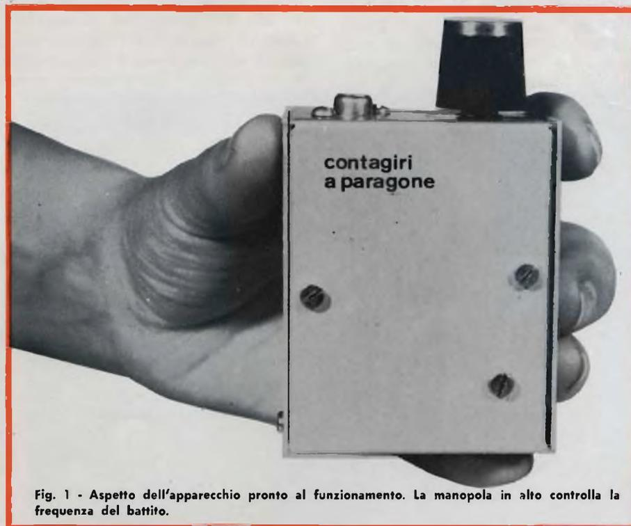
Fig. 1 - Aspetto dell'apparecchio pronto al funzionamento. La manopola in alto controlla la frequenza del battito.
