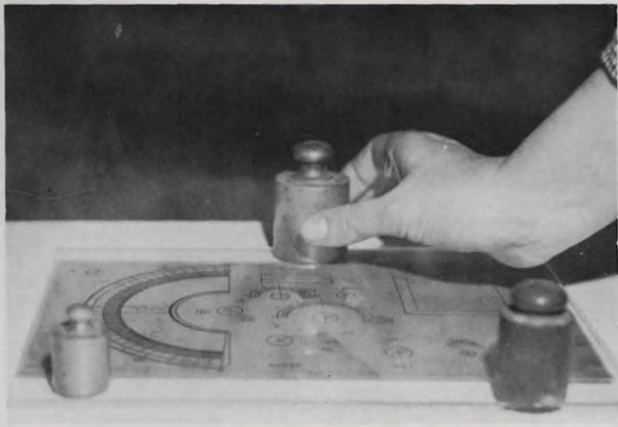
Fig. 3 - Per ottenere fotografie nitide, il disegno e la lastra metallica vanno fatti aderire perfettamente fra loro sovrapprendovi un cristallo caricato con pesi.
