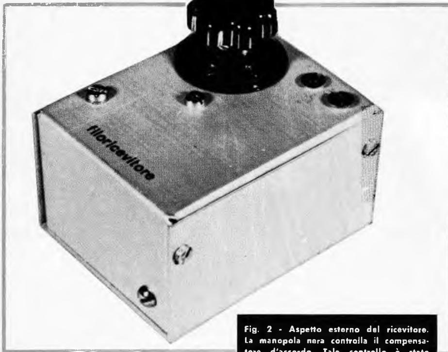
Fig. 2 - Aspecto esterno del ricevitore. La manopola nera controlla il compensatore d'accordo. Tale controllo è stato adottato solo in via sperimentale, nella edizione definitiva è stato eliminato, essendo la stabilità di taratura risultata ottima.
