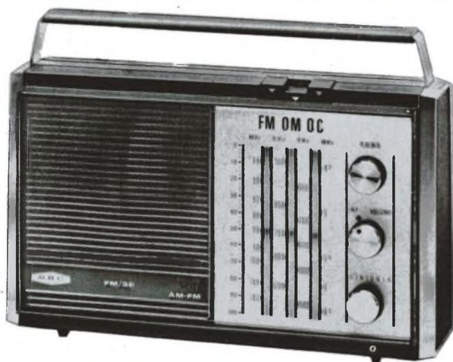
Le principali caratteristiche del radioricevitore portatile a transistor per FM - OM - OC FM/38 « ODIC » sono: 8 transistor + 5 diodi + 1 raddrizzatore. Antenna: in ferroxube per OM-OC; telescopica per FM. Presa per antenna esterna. Selezione gamme d'onda a tastiera. Controlli di volume e di tono a regolazione continua. Potenza di uscita 800 mW. Alimentazione mista: in c.a. 110 ÷ 220 V; in c.c. mediante 2 pile da 4,5 V. Dimensioni: 315 x 190 x 90. Peso: 1800 g.
