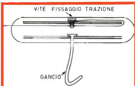
Fig. 3 - Veduta in sezione del carrello, onde chiarire la posizione della vite di fissaggio della fune di trazione, e quella del gancio di sospensione della cabina. E' illustrato anche il metodo di applicazione della fune, nei confronti di uno dei suoi estremi.
