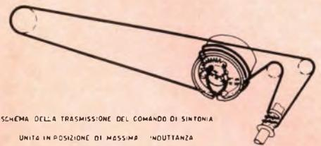
SCHEMA DELLA TRASMISSIONE DEL COMANDO DI SINTONIA
