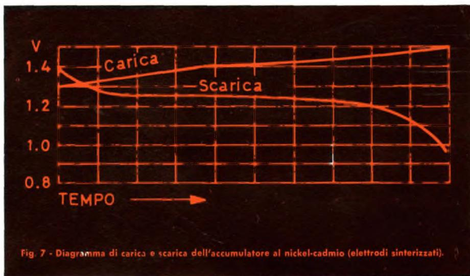
Fig. 7 - Diagramma di carica e scarica dell'accumulatore al nickel-cadmio (elettrodi sinterizzati).
