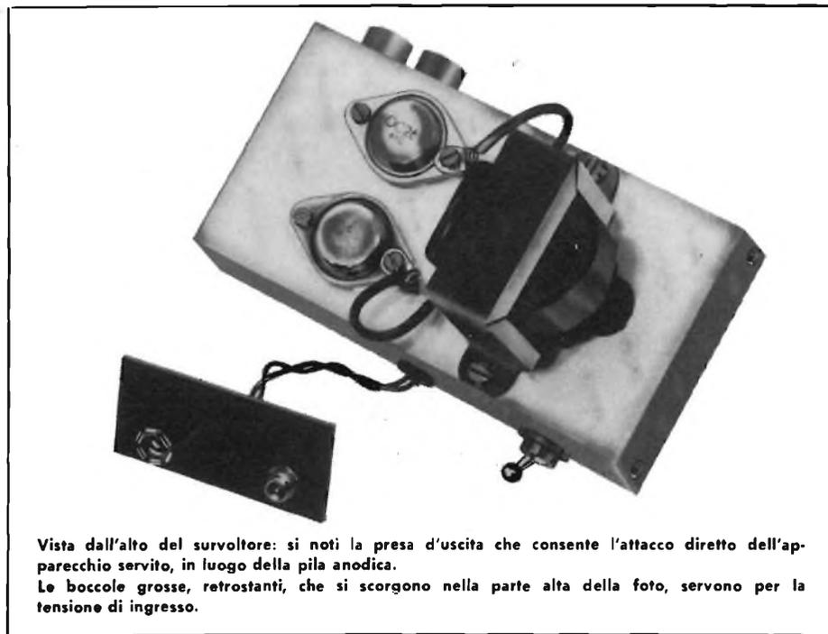
Vista dall'alto del survoltore: si noti la presa d'uscita che consente l'attacco diretto dell'apparecchio servito, in luogo della pila anodica. Le boccole grosse, retrostanti, che si scorgono nella parte alta della foto, servono per la tensione di ingresso.
