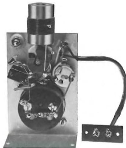
**Vista posteriore del « Minidip »:** il cavo sulla destra è quello di alimentazione. Si noti il diodo rivelatore, direttamente collegato ai morsetti dell'indicatore e la brevità dei collegamenti della radiofrequenza senza alcuna curvatura.
