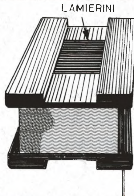
Fig. 6 - Aspetto della bobina captatrice, e metodo di introduzione dei lamierini che ne aumentano la sensibilità agli effetti del campo magnetico irradiato dalle spire.
