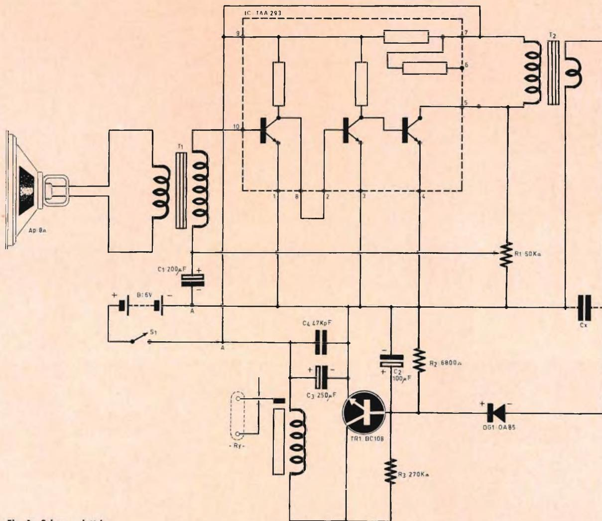
Fig. 1 - Schema elettrico.
