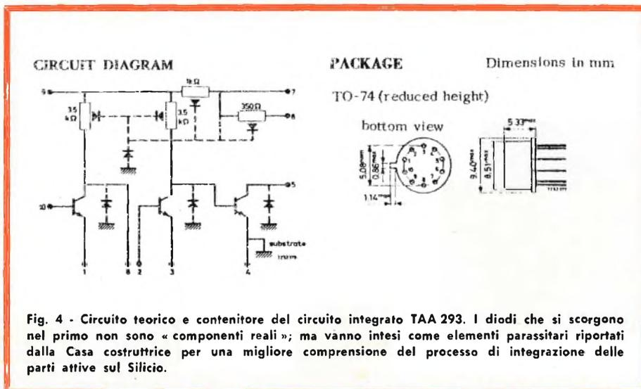
Fig. 4 - Circuito teorico e contenitore del circuito integrato TAA 293. I diodi che si scorgono nel primo non sono « componenti reali »; ma vanno intesi come elementi parassitari riportati dalla Casa costruttrice per una migliore comprensione del processo di integrazione delle parti attive sul Silicio.
