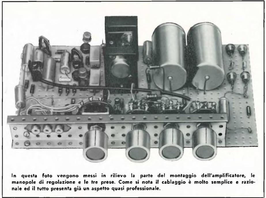
In questa foto vengono messi in rilievo la parte del montaggio dell'amplificatore, le manopole di regolazione e le tre prese. Come si nota il cablaggio è molto semplice e razionale ed il tutto presenta già un aspetto quasi professionale.
