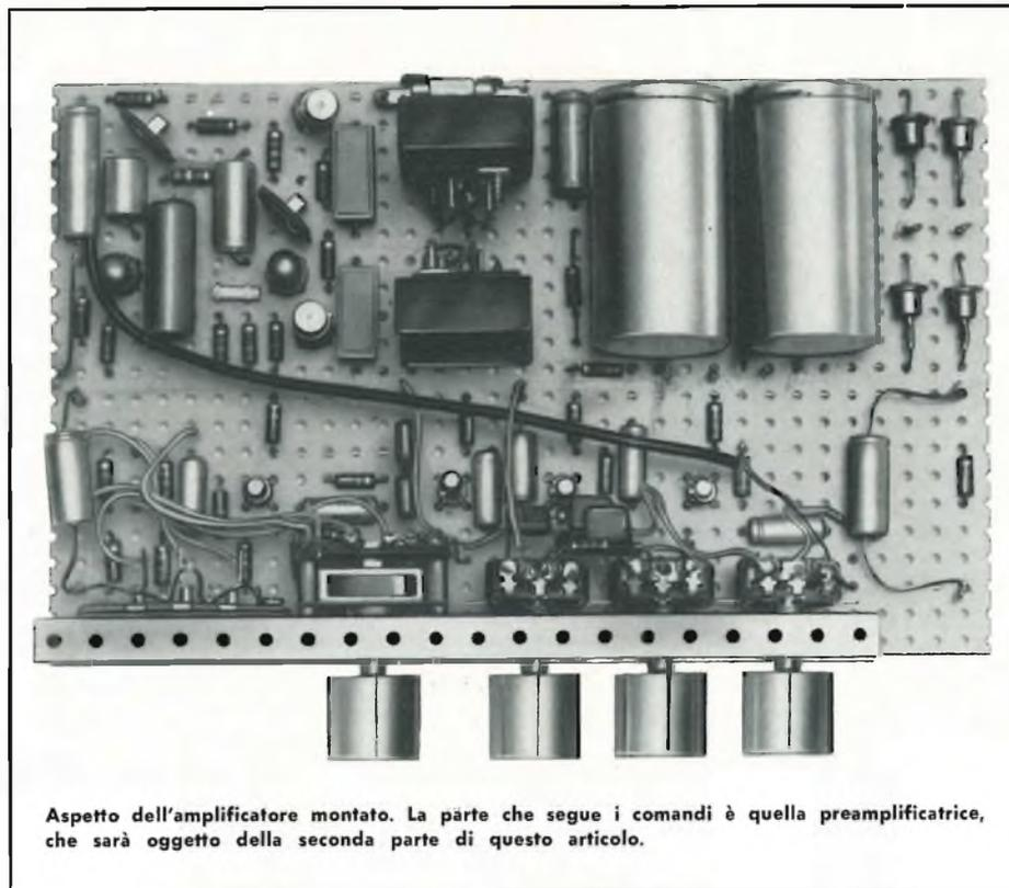
Aspetto dell'amplificatore montato. La parte che segue i comandi è quella preamplificatrice, che sarà oggetto della seconda parte di questo articolo.
