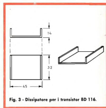
Fig. 3 - Dissipatore per i transistor BD 116.
