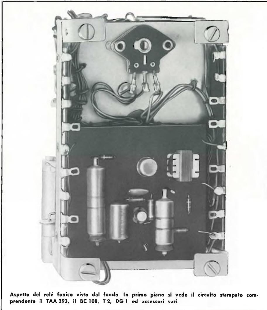
Aspetto del relé fonico visto dal fondo. In primo piano si vede il circuito stampato comprendente il TAA 293, il BC 108, T2, DG 1 ed accessori vari.
