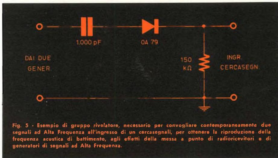
**Fig. 5** - Esempio di gruppo rivelatore, necessario per convogliare contemporaneamente due segnali ad Alta Frequenza all'ingresso di un cercasegnali, per ottenere la riproduzione della frequenza acustica di battimento, agli effetti della messa a punto di radioricevitori e di generatori di segnali ad Alta Frequenza.
