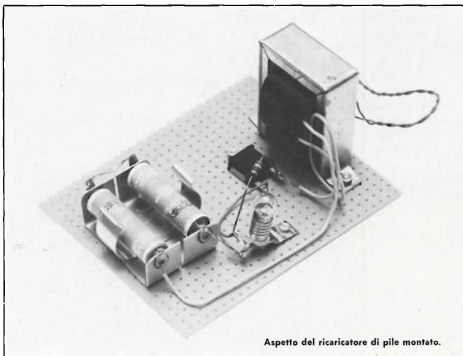
Aspetto del ricaricatore di pile montato.
