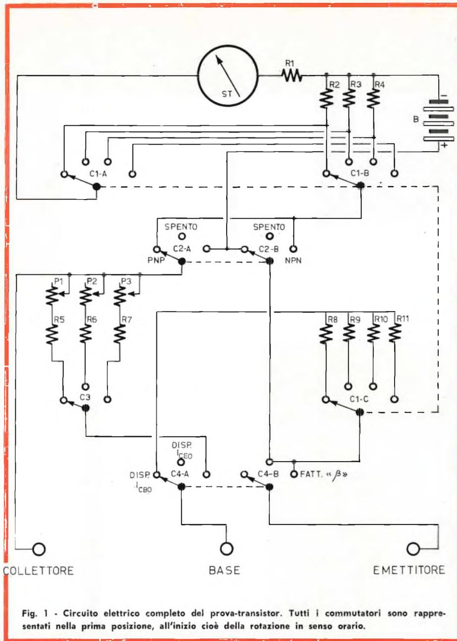
Fig. 1 - Circuito elettrico completo del prova-transistor. Tutti i commutatori sono rappresentati nella prima posizione, all'inizio cioè della rotazione in senso orario.
