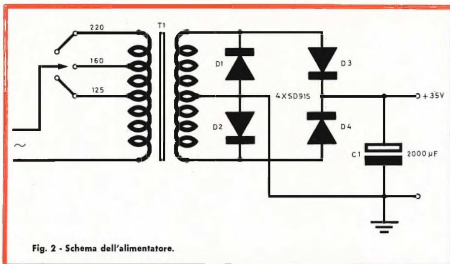
Fig. 2 - Schema dell'alimentatore.
