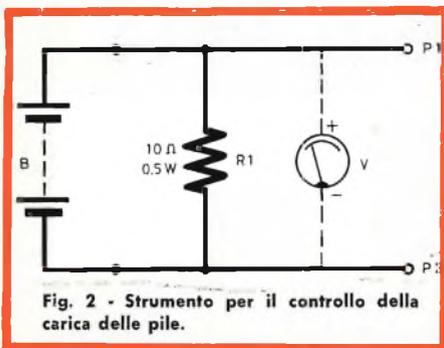
Fig. 2 - Strumento per il controllo della carica delle pile.
