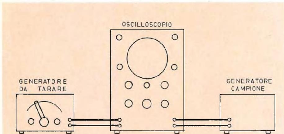
Fig. 3 - Rappresentazione grafica della disposizione tipica del generatore campione, dell'oscilloscopio, e del generatore sotto prova, necessario per effettuare la messa a punto del quadrante di sintonia di un generatore di segnali a Bassa Frequenza.
