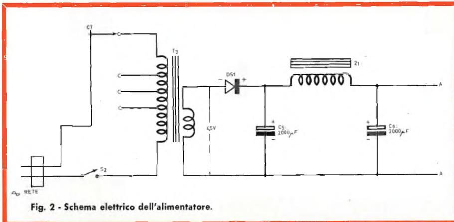
Fig. 2 - Schema elettrico dell'alimentatore.
