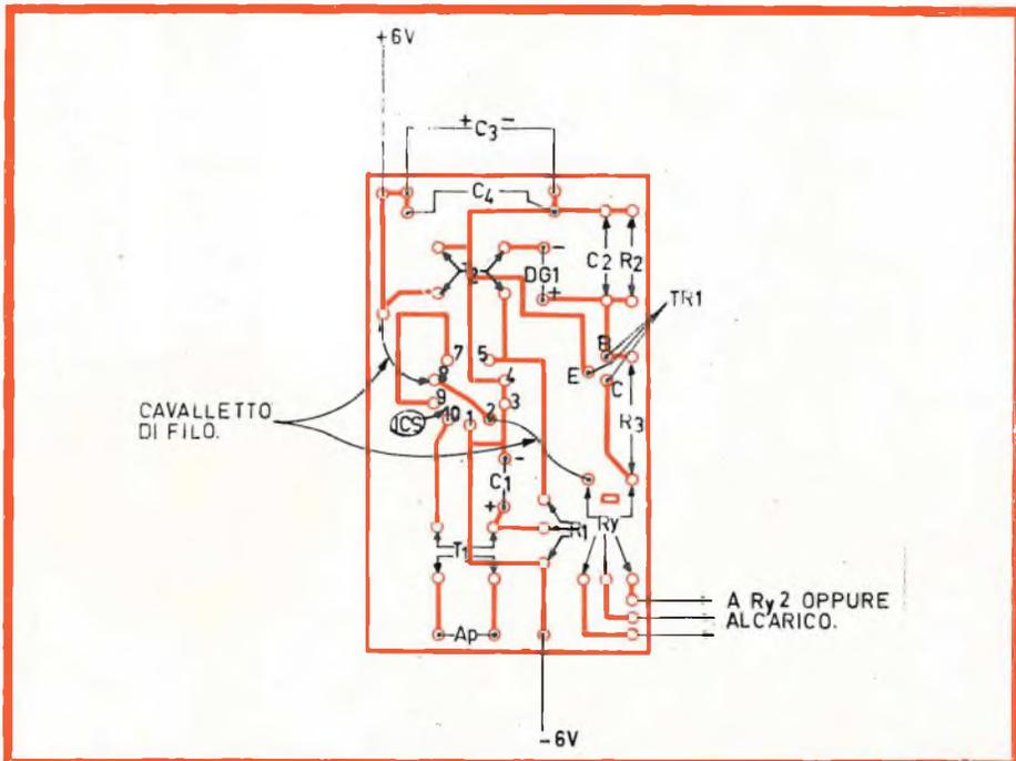
Fig. 3 - Circuito stampato del relé fonico. Nel prototipo, il trasformatore « T1 » non si trova sul pannello, ma è sistemato immediatamente sotto all'altoparlante. Le due soluzioni, sotto il profilo funzionale si equivalgono. Il relé « RC1 » può essere montato sul circuito stampato, ma volendo semplificare le connessioni, è forse conveniente che sia fissato al di fuori di questo, su di una staffa metallica rigida, come nel prototipo illustrato dalle fotografie.
