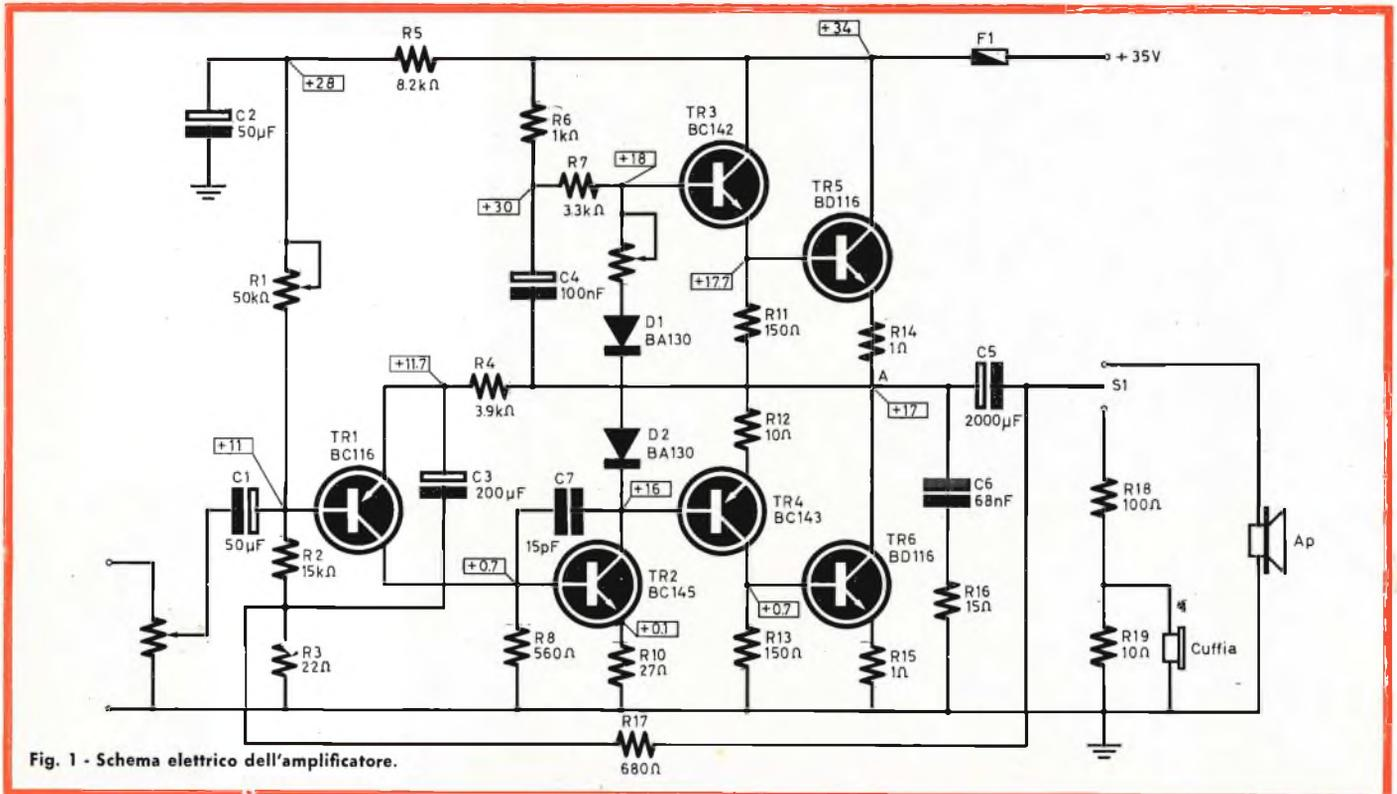
Fig. 1 - Schema elettrico dell'amplificatore.
