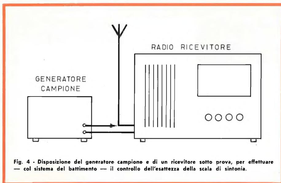
Fig. 4 - Disposizione del generatore campione e di un ricevitore sotto prova, per effettuare — col sistema del battimento — il controllo dell'esattezza della scala di sintonia.
