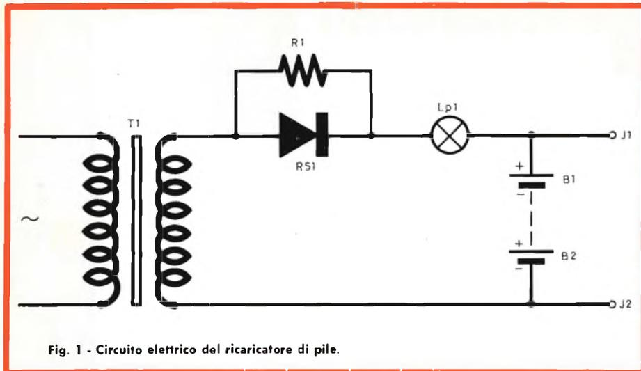
Fig. 1 - Circuito elettrico del ricaricatore di pile.
