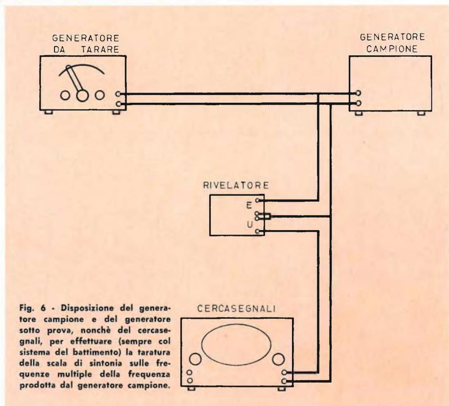
**Fig. 6** - Disposizione del generatore campione e del generatore sotto prova, nonché del cercasegnali, per effettuare (sempre col sistema del battimento) la taratura della scala di sintonia sulle frequenze multiple della frequenza prodotta dal generatore campione.
