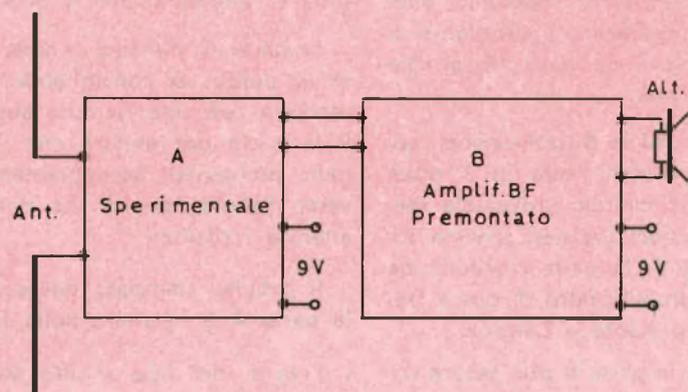
Fig. 1 - Parte sperimentale (A) + amplificatore BF (B) = Rx (ricevitore completo).
