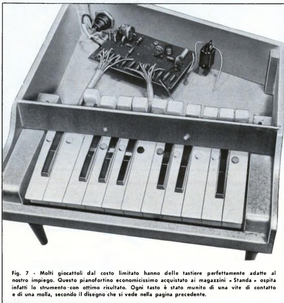
Fig. 7 - Molti giocattoli dal costo limitato hanno delle tastiere perfettamente adatte al nostro impiego. Questo pianofortino economicissimo acquistato ai magazzini « Standa » ospita infatti lo strumento con ottimo risultato. Ogni tasto è stato munito di una vite di contatto e di una molla, secondo il disegno che si vede nella pagina precedente.
