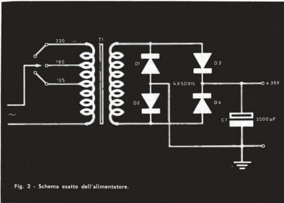
Fig. 2 - Schema esatto dell'alimentatore.
