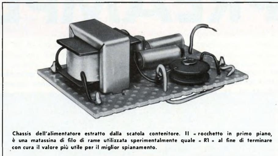
Chassis dell'alimentatore estratto dalla scatola contenitore. Il « rochetto in primo piano, è una matassina di filo di rame utilizzata sperimentalmente quale « R1 » al fine di terminare con cura il valore più utile per il miglior spianamento.
