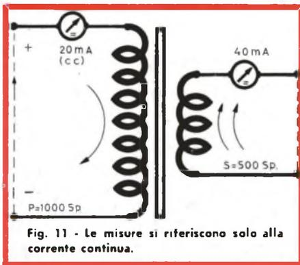
Fig. 11 - Le misure si riferiscono solo alla corrente continua.
