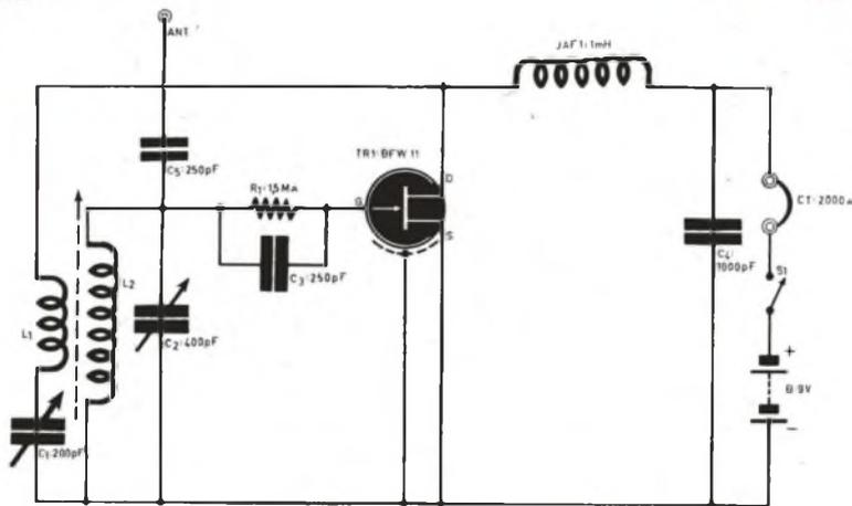
Fig. 2 - Circuito impiegante un transistor FET
