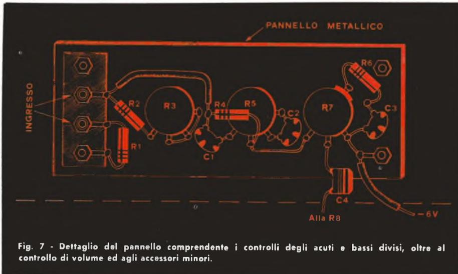
Fig. 7 - Dettaglio del pannello comprendente i controlli degli acuti e bassi divisi, oltre al controllo di volume ed agli accessori minori.
