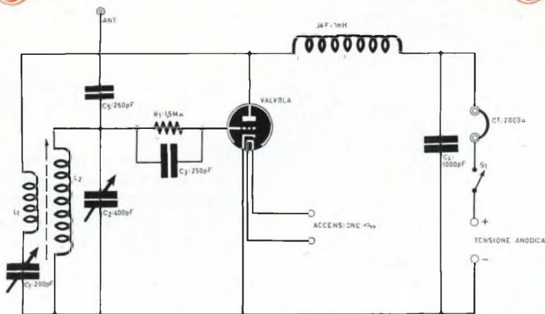
**Fig. 1 - Circuito di principio impiegante un triodo valvola.**
