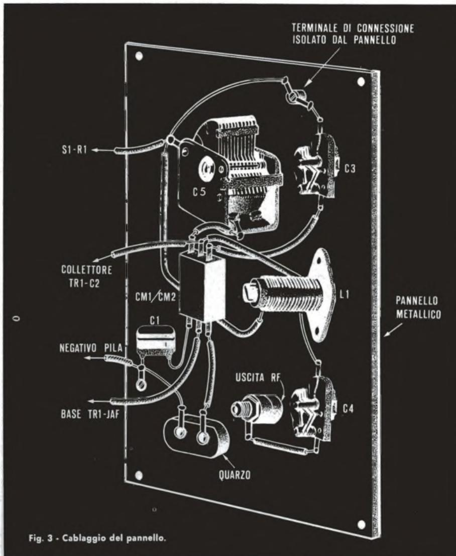
Fig. 3 - Cablaggio del pannello.
