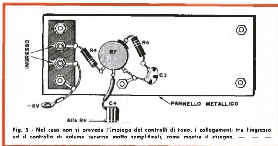
Fig. 5 - Nel caso non si preveda l'impiego dei controlli di tono, i collegamenti tra l'ingresso ed il controllo di volume saranno molto semplificati, come mostra il disegno. — — —
