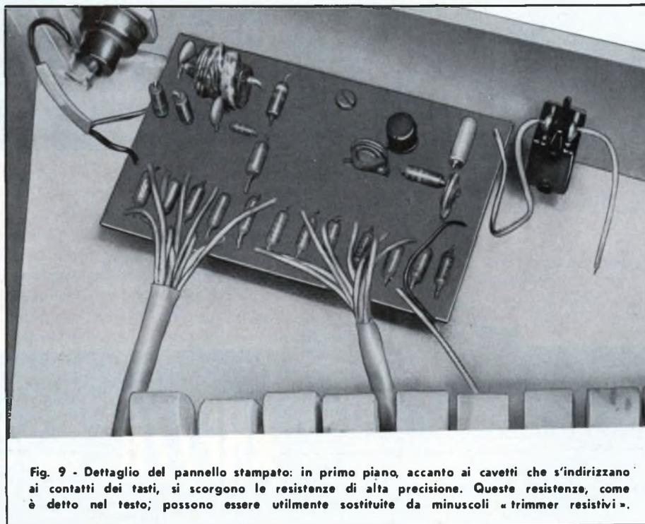
Fig. 9 - Dettaglio del pannello stampato: in primo piano, accanto ai cavetti che s'indirizzano ai contatti dei tasti, si scorgono le resistenze di alta precisione. Queste resistenze, come è detto nel testo, possono essere utilmente sostituite da minuscoli « trimmer resistivi ».
