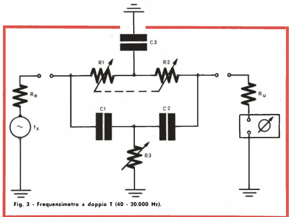
Fig. 3 - Frequenzimetro a doppio T (40 - 20.000 Hz).
