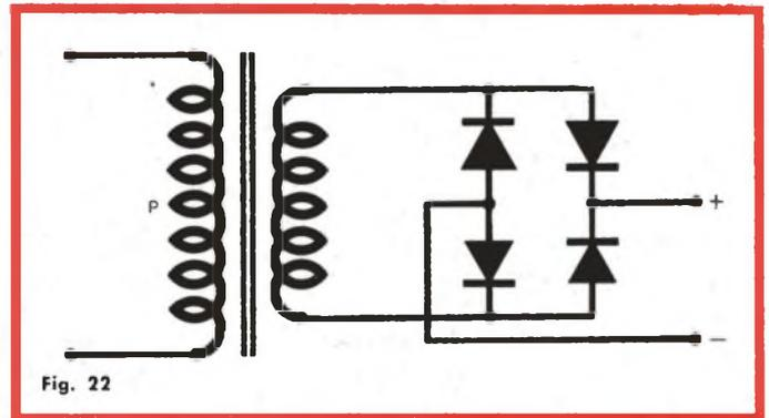
Ecco infine lo schema di un piccolo carica-batterie per auto da 12 V, semplice ed economico, di facile costruzione e di duraturo funzionamento. Il trasformatore ha 6 spire/volt. Si noterà che il numero delle spire del secondario, che è vantaggioso avvolgere per primo, è ottenuto, secondo quanto già trattato più avanti, con le seguenti semplici operazioni:
