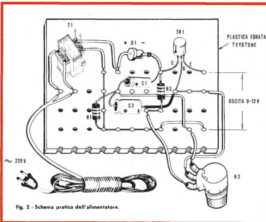
Fig. 2 - Schema pratico dell'alimentatore.
