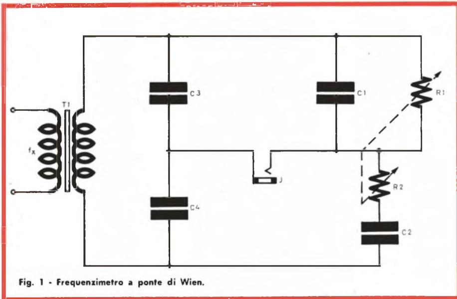
Fig. 1 - Frequenzimetro a ponte di Wien.
