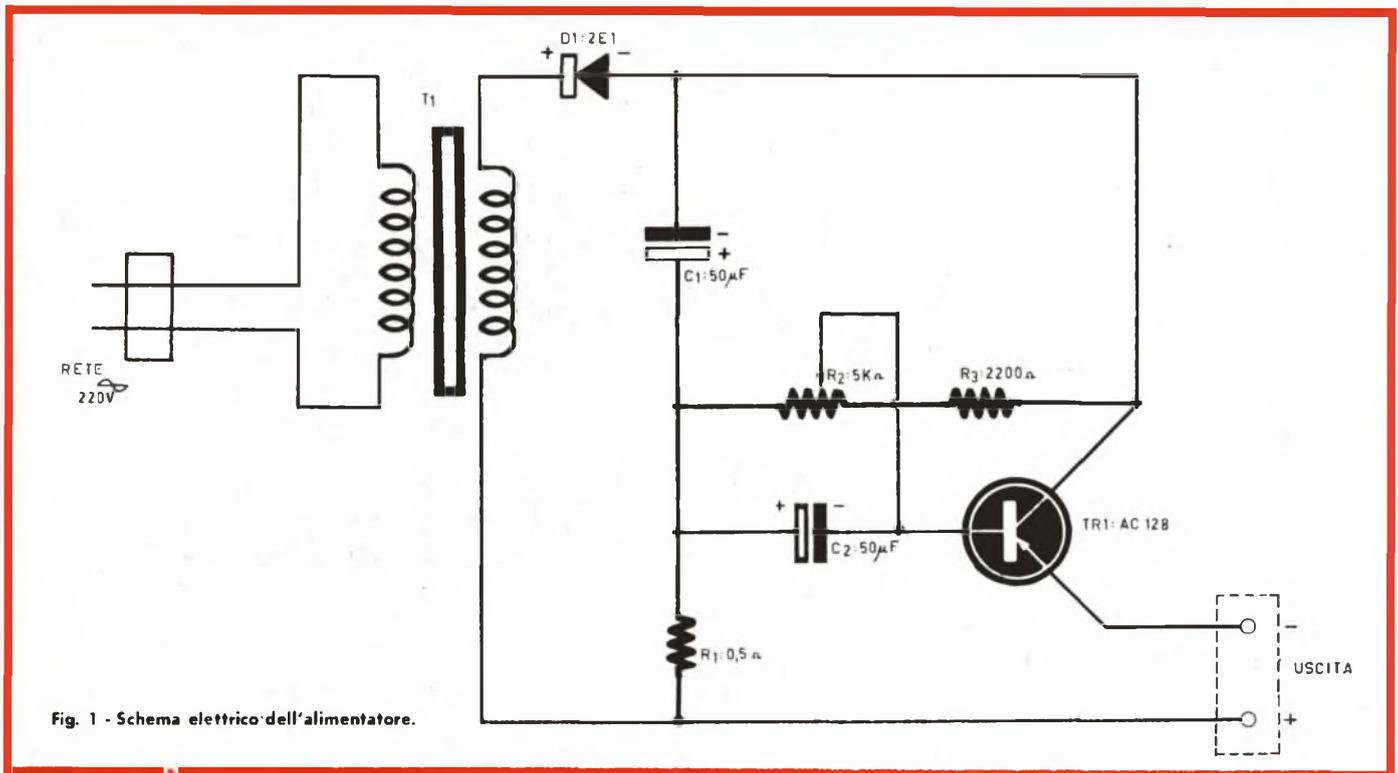
Fig. 1 - Schema elettrico dell'alimentatore.
