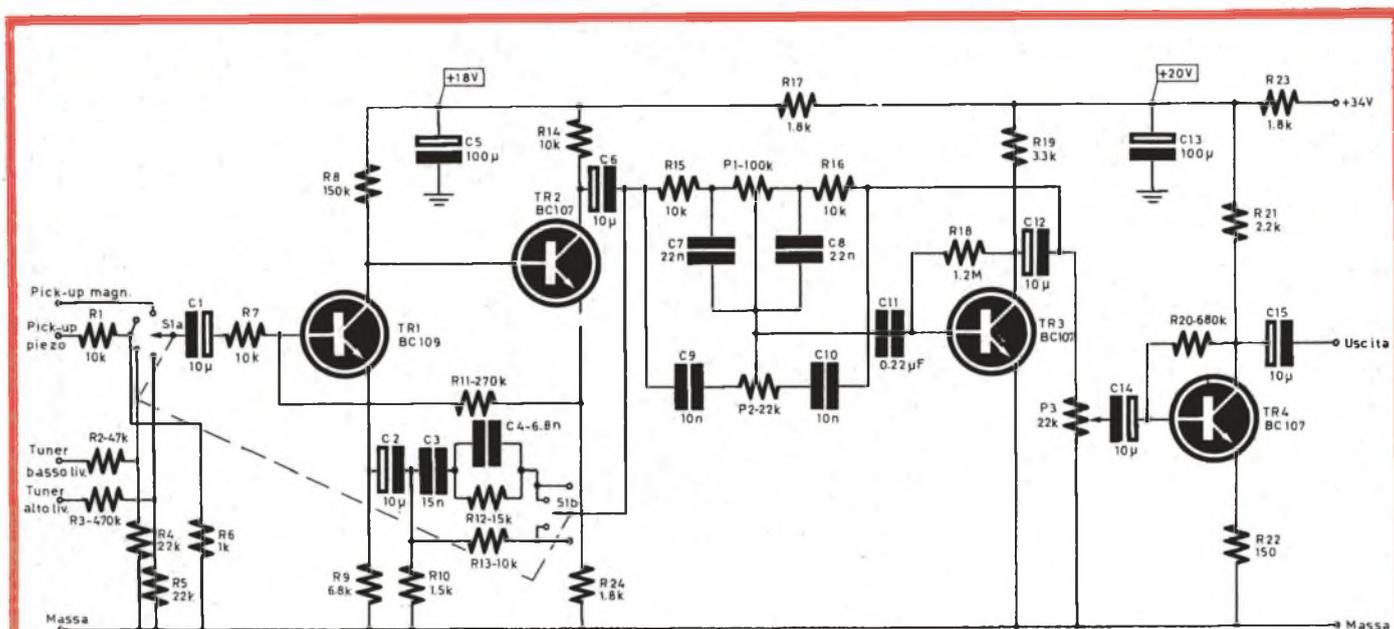
Fig. 1 - Schema elettrico del preamplificatore Hi-Fi. La foto in alto mostra l'amplificatore, pubblicato sul n. 10 - 1968, ed il preamplificatore montati.
