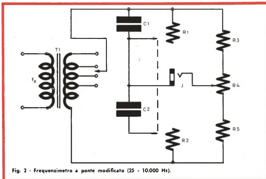
Fig. 2 - Frequenzimetro a ponte modificato (25 - 10.000 Hz).
