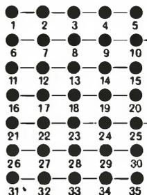
Le piastre possono essere collegate ad incastro per formare circuiti di qualunque dimensione. I componenti vengono semplicemente inseriti nei contatti, senza saldatura alcuna, ed estratti con altrettanta semplicità quando occorre.
