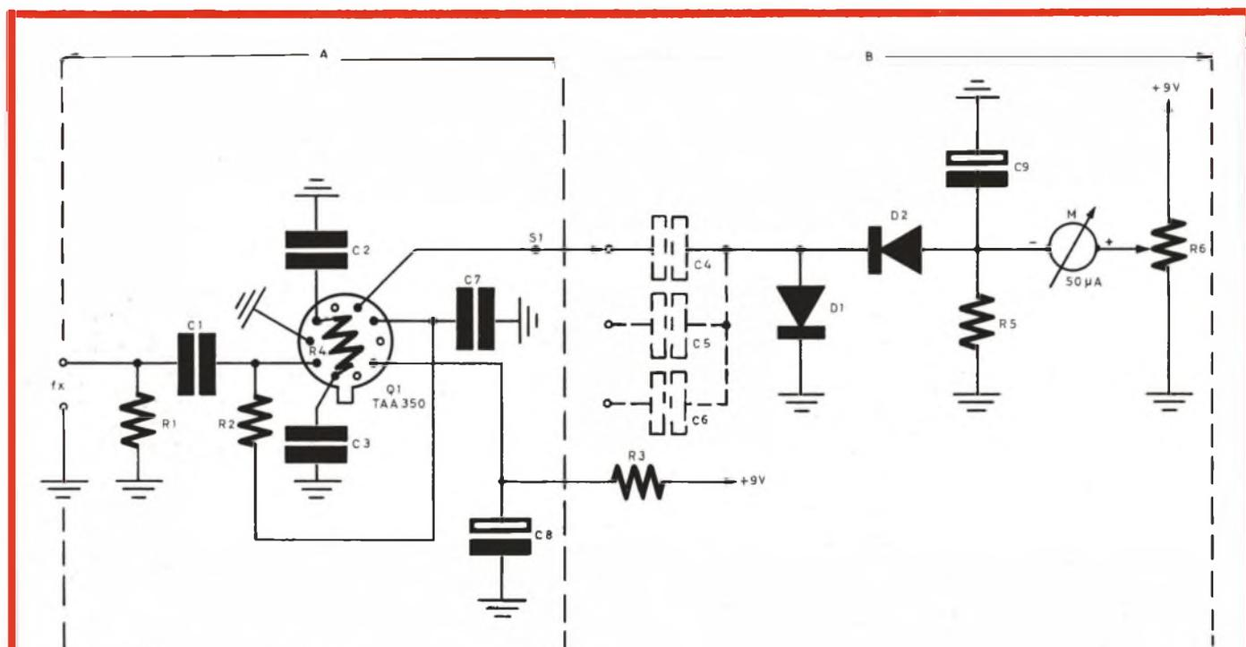
Fig. 5 - Frequenzimetro con circuito integrato (5 - 50 MHz).
