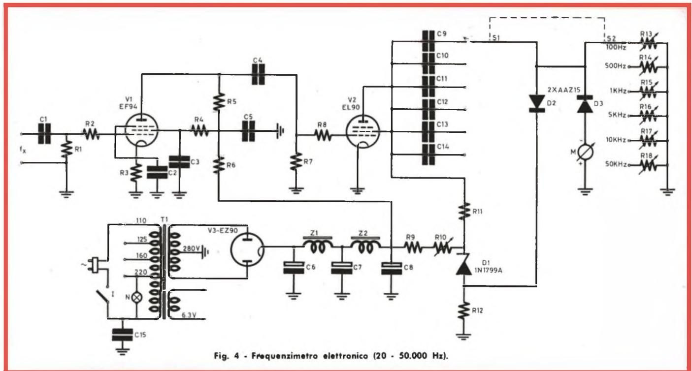
Fig. 4 - Frequenzimetro elettronico (20 - 50.000 Hz).
