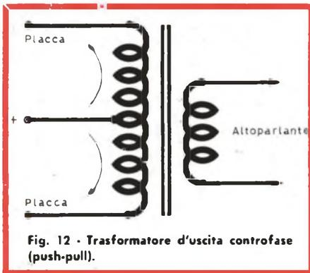
Fig. 12 - Trasformatore d'uscita controfase (push-pull).
