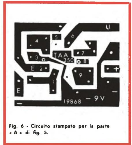
Fig. 6 - Circuito stampato per la parte « A » di fig. 5.
