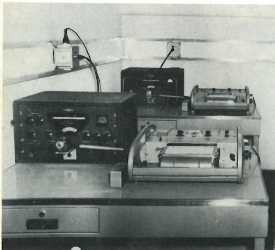
Fig. 1 - Registratori di banda funzionanti automaticamente senza la presenza di un operatore.
