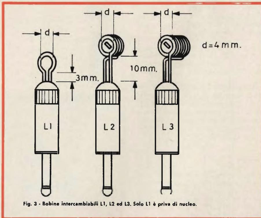
Fig. 3 - Bobine intercambiabili L1, L2 ed L3. Solo L1 è priva di nucleo.
