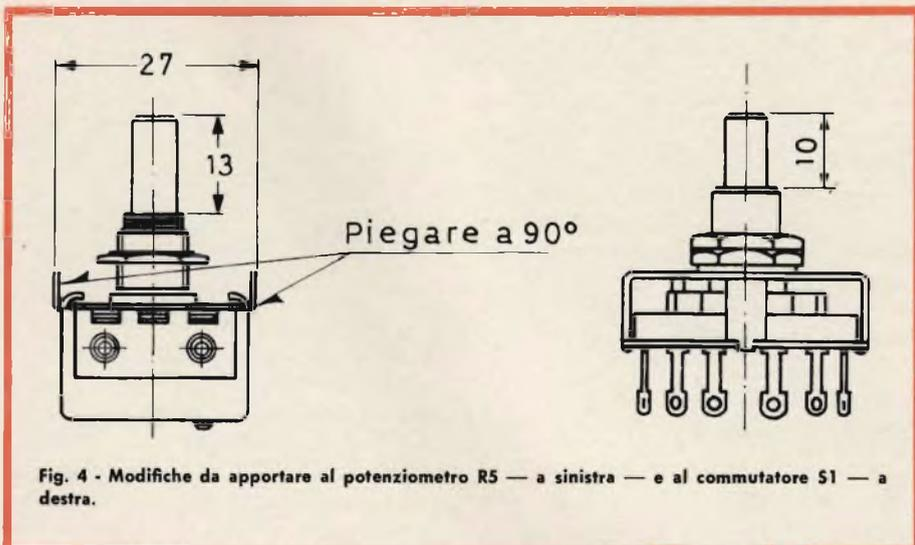
Fig. 4 - Modifiche da apportare al potenziometro R5 — a sinistra — e al commutatore S1 — a destra.
