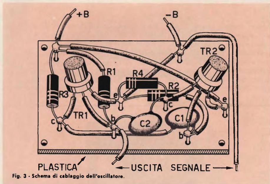
Fig. 3 - Schema di cablaggio dell'oscillatore.
