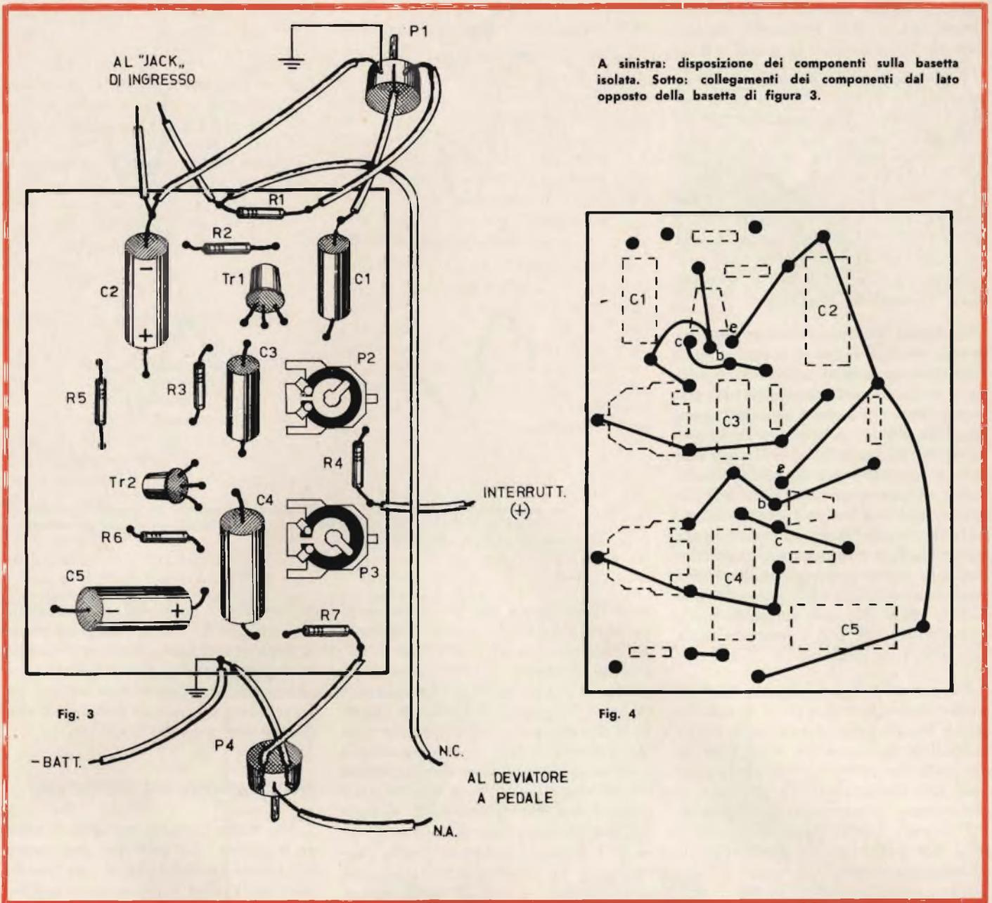
A sinistra: disposizione dei componenti sulla basetta isolata. Sotto: collegamenti dei componenti dal lato opposto della basetta di figura 3.
