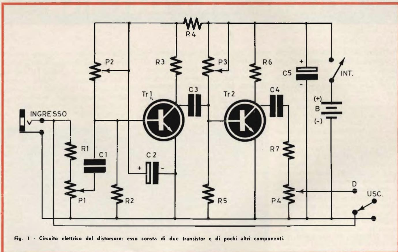
Fig. 1 - Circuito elettrico del distorsore: esso consta di due transistor e di pochi altri componenti.
