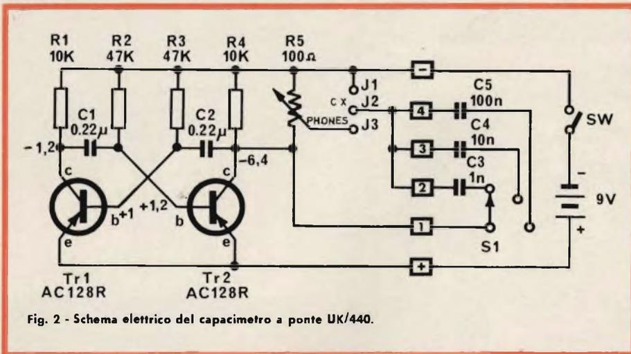
Fig. 2 - Schema elettrico del capacimetro a ponte UK/440.
