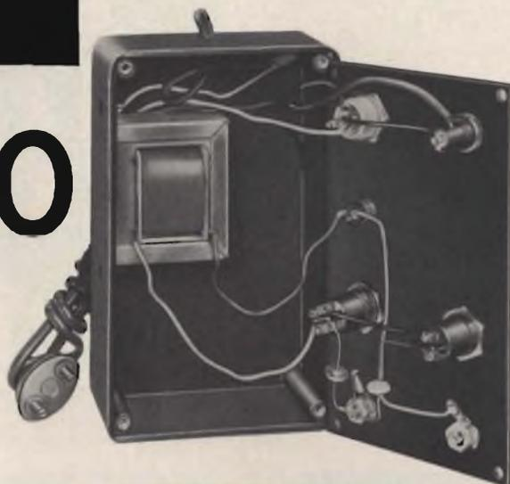
Fig. 3 - Aspecto del provadiodi sistemato nel contenitore.
