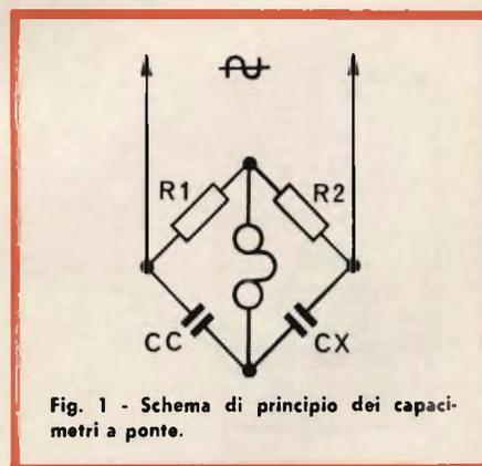
Fig. 1 - Schema di principio dei capaciometri a ponte.
