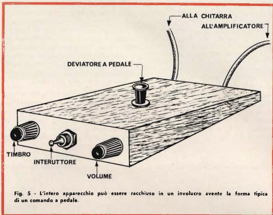
Fig. 5 - L'intero apparecchio può essere racchiuso in un involucro avente la forma tipica di un comando a pedale.
