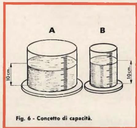
Fig. 6 - Concetto di capacità.
