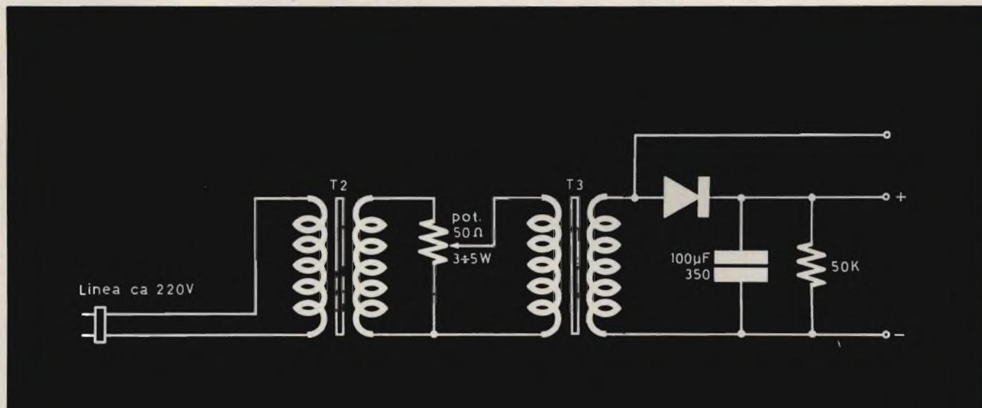
Fig. 3 - Ecco lo schema elettrico di un alimentatore a tensione variabile con continuità. Esso può venire realizzato con facilità con i residui di laboratorio e dà ottimi risultati nella generazione di tensione di polarizzazione o di controllo per la strumentazione.
