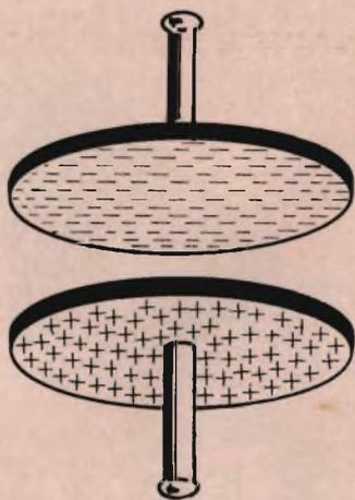
Fig. 7 - Condensatore elementare.
