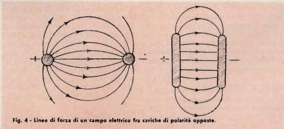
Fig. 4 - Linee di forza di un campo elettrico fra cariche di polarità opposte.
