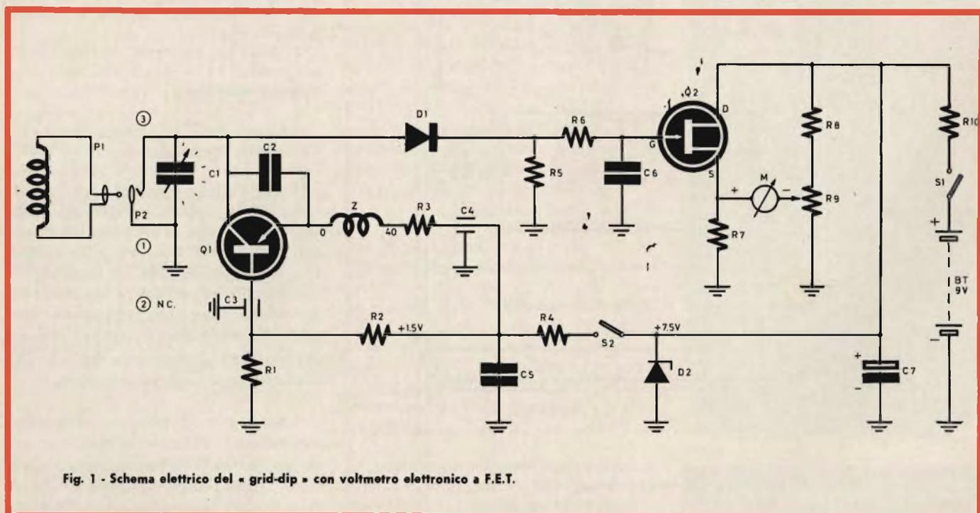
Fig. 1 - Schema elettrico del « grid-dip » con voltmetro elettronico a F.E.T.
