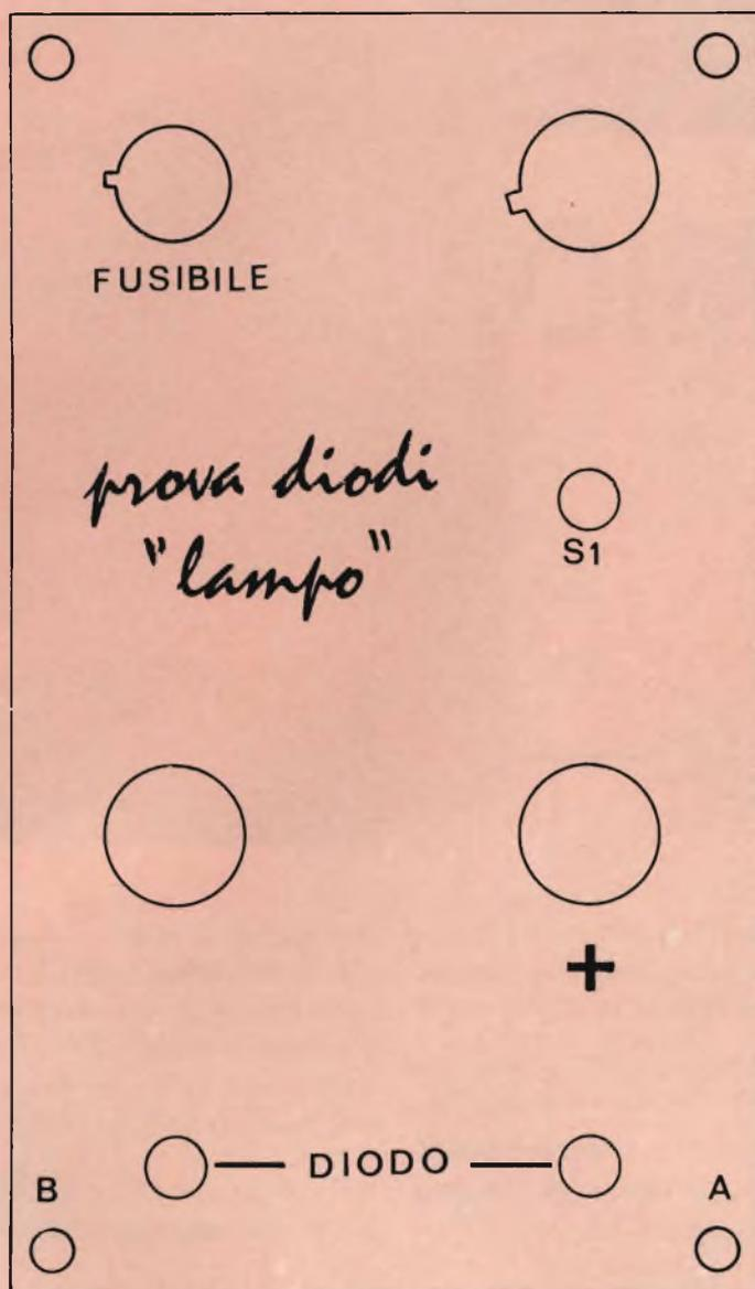
Fig. 3 - Pannello dello strumento - scala 1 : 1.
