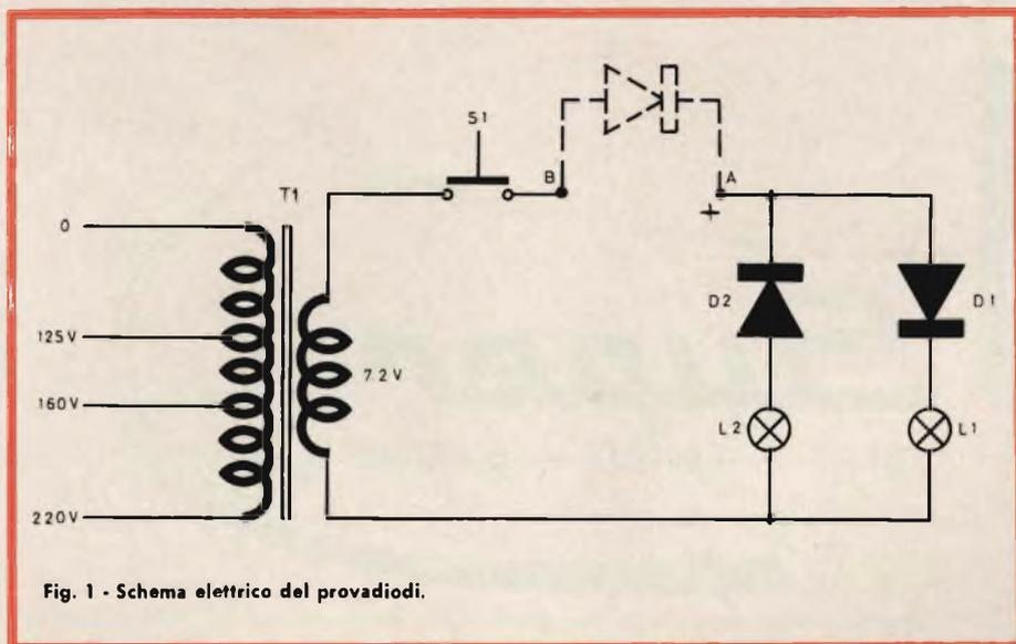
Fig. 1 - Schema elettrico del provadiodi.
