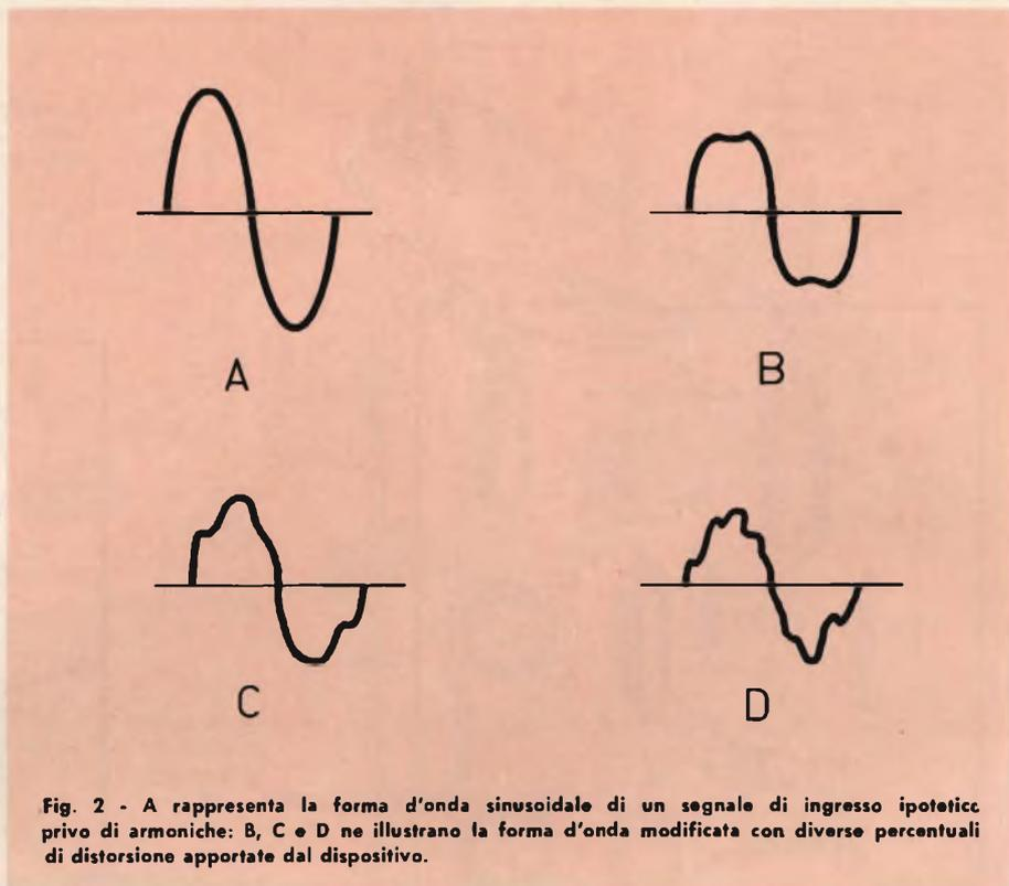
Fig. 2 - A rappresenta la forma d'onda sinusoidale di un segnale di ingresso ipotetico privo di armoniche; B, C e D ne illustrano la forma d'onda modificata con diverse percentuali di distorsione apportate dal dispositivo.
