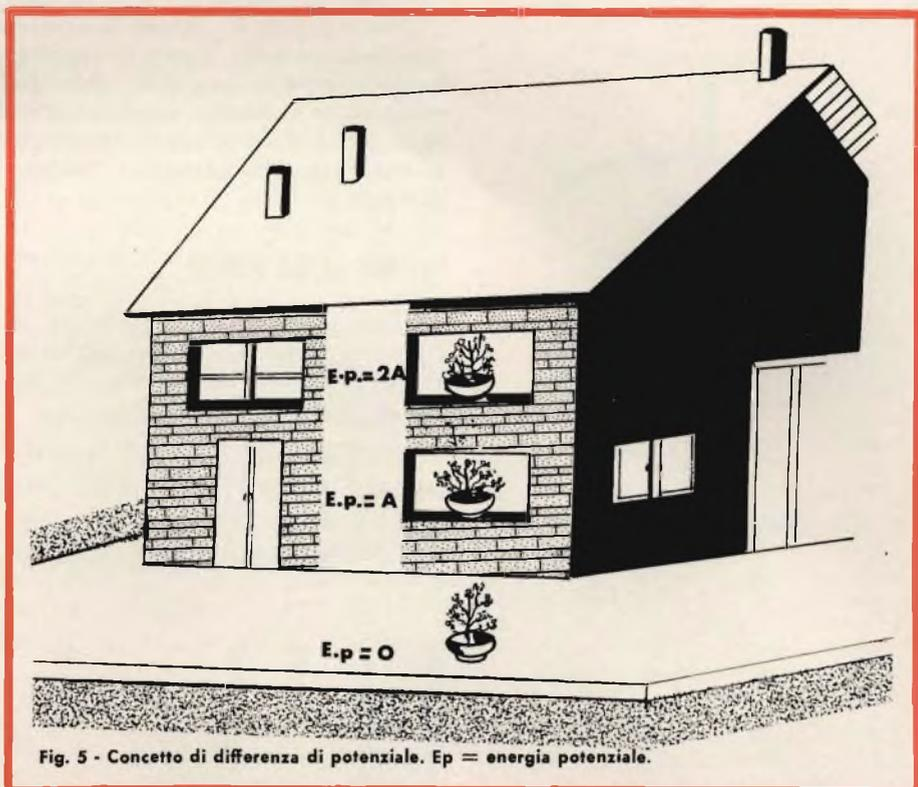
Fig. 5 - Concetto di differenza di potenziale. Ep = energia potenziale.
