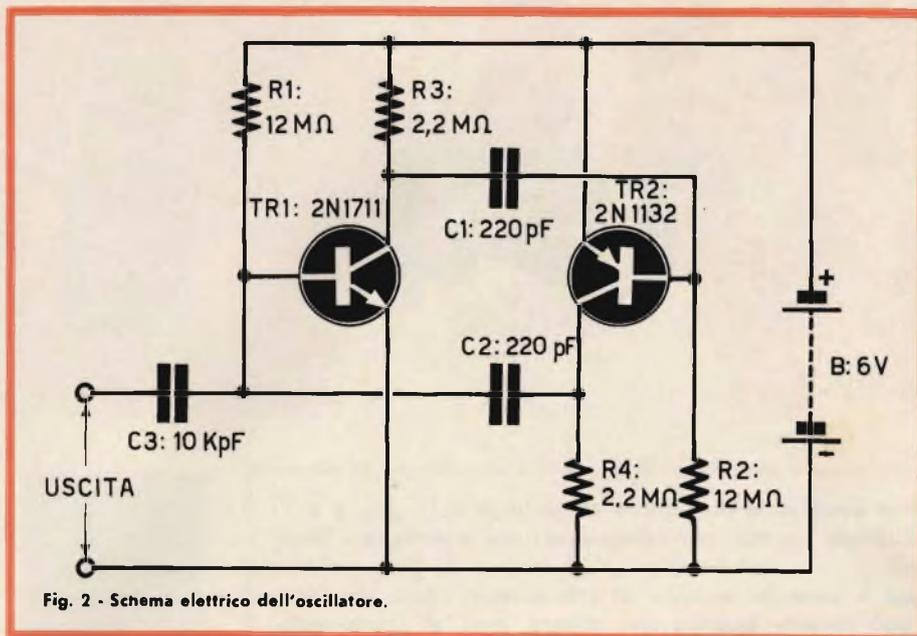
Fig. 2 - Schema elettrico dell'oscillatore.
