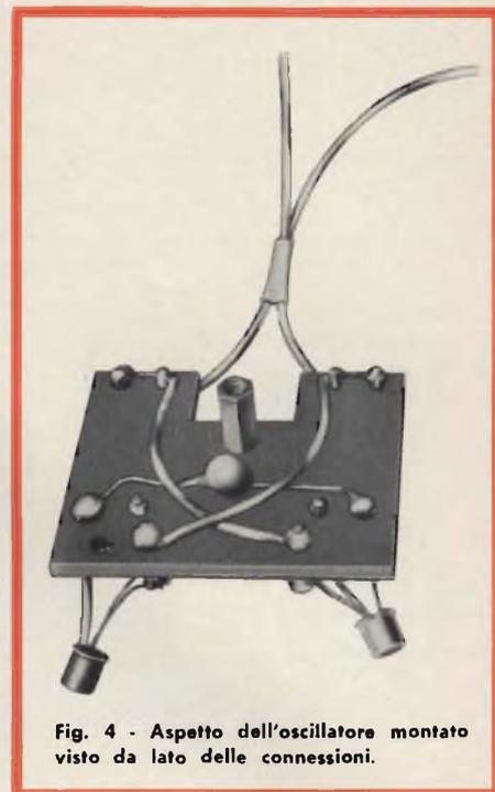
Fig. 4 - Aspetto dell'oscillatore montato visto da lato delle connessioni.
