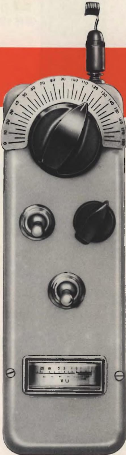
Aspetto del « grid-dip » montato.
