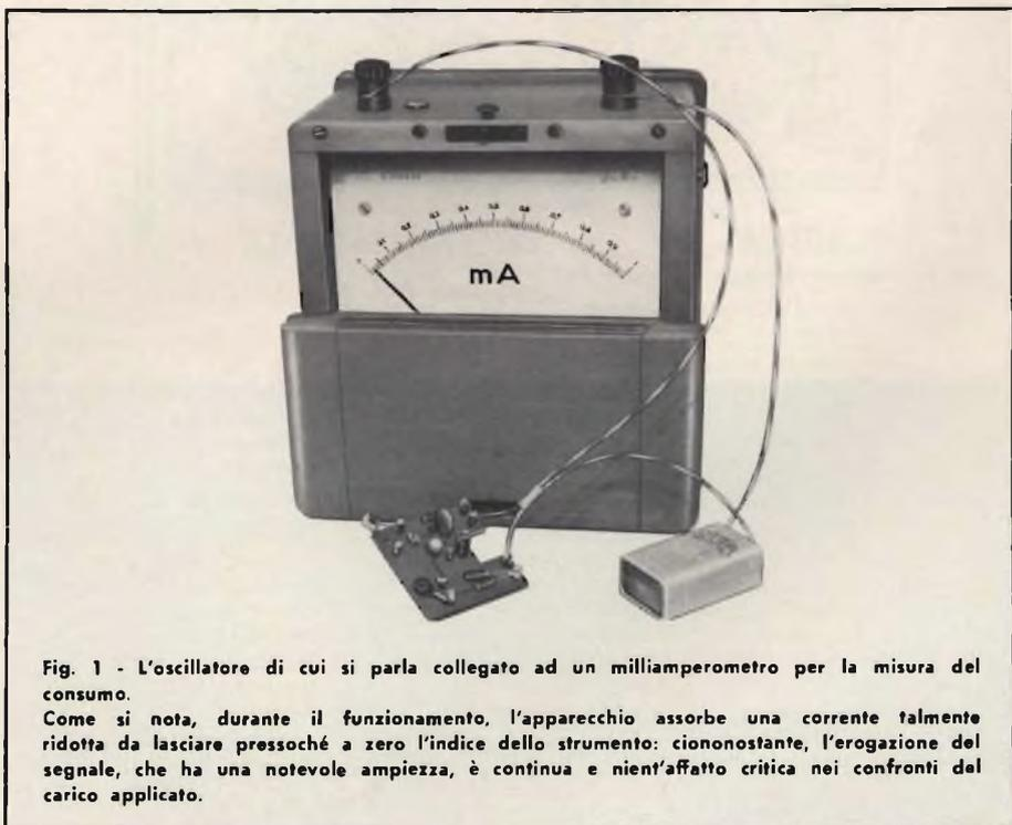
Fig. 1 - L'oscillatore di cui si parla collegato ad un milliamperometro per la misura del consumo.
