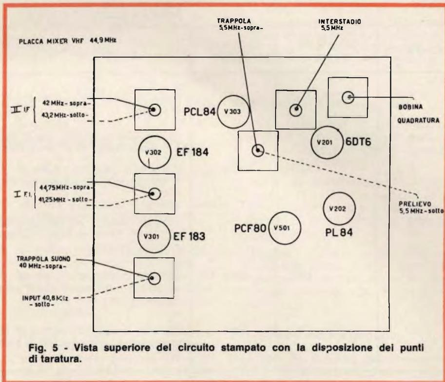
Fig. 5 - Vista superiore del circuito stampato con la disposizione dei punti di taratura.
