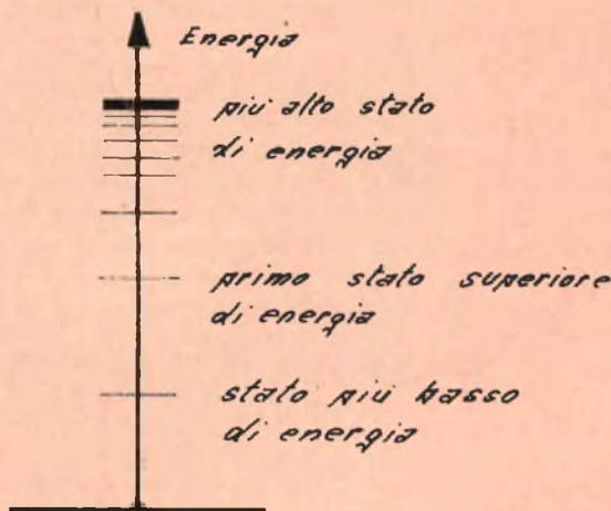
Fig. 2 - A temperatura ambiente, la maggior parte degli elettroni si trova al suo più basso stato di energia, ma, sotto l'azione della corrente elettrica o del calore essi possono acquistare uno stato di energia più elevato.
