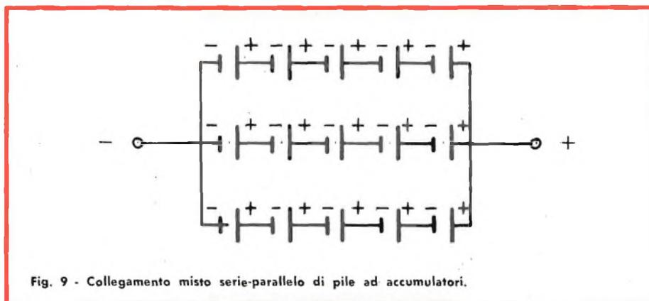
Fig. 9 - Collegamento misto serie-parallelo di pile ed accumulatori.
