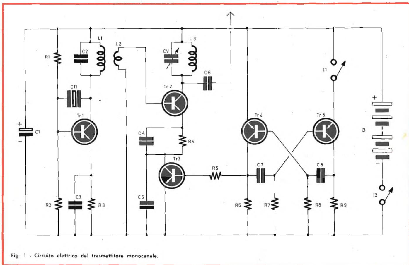
Fig. 1 - Circuito elettrico del trasmettitore monocanale.
