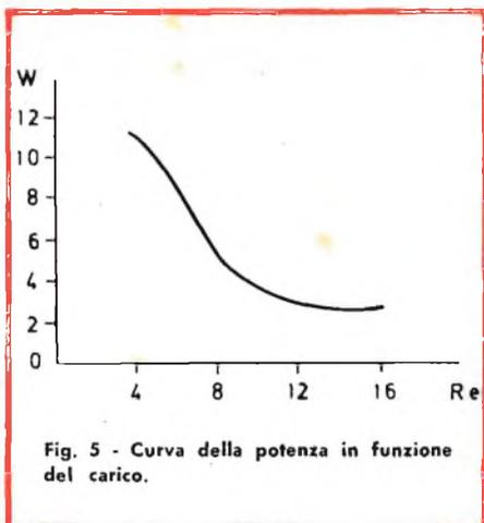
Fig. 5 - Curva della potenza in funzione del carico.
