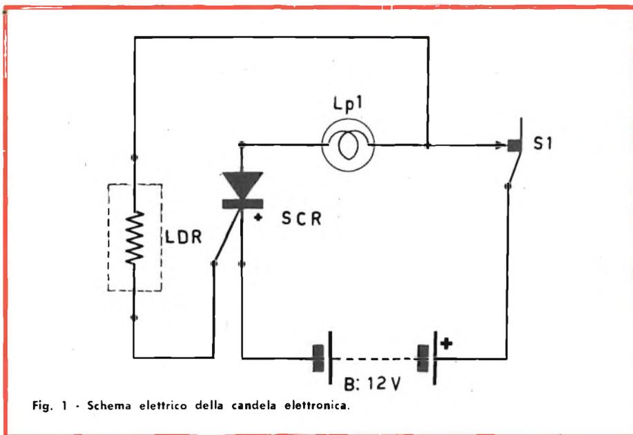
Fig. 1 - Schema elettrico della candela elettronica.
