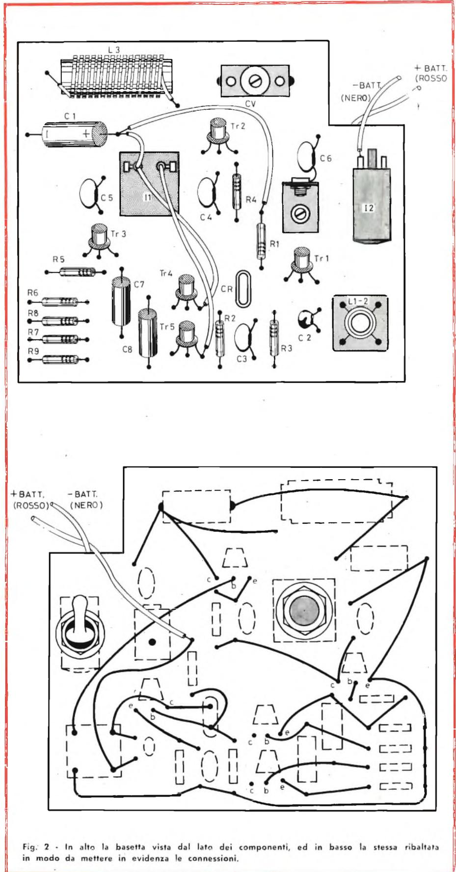
Fig. 2 - In alto la basetta vista dal lato dei componenti, ed in basso la stessa ribaltata in modo da mettere in evidenza le connessioni.
