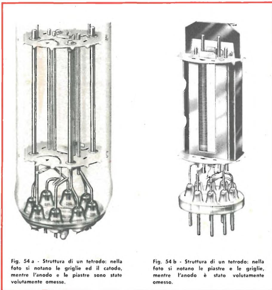
Fig. 54 a - Struttura di un tetrodo: nella foto si notano le griglie ed il catodo, mentre l'anodo e le piastre sono state volutamente omesse.
