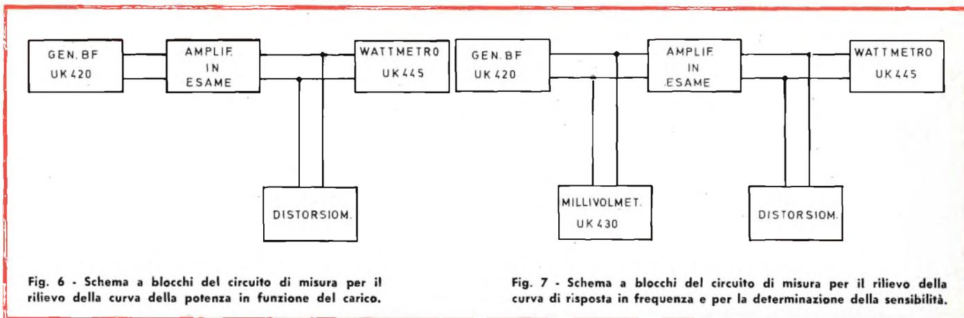
Fig. 6 - Schema a blocchi del circuito di misura per il rilievo della curva della potenza in funzione del carico.
