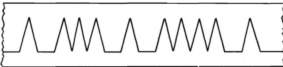
Fig. 8 - Il tracciato ottenuto sul nastro di carta dell'apparecchio precedentemente descritto era costituito da una linea dritta finché la corrente era interrotta. Quando veniva stabilito un breve contatto, veniva tracciato un dente di sega. Questo procedimento, che non permetteva di rappresentare le lettere e le cifre con un numero di denti determinato, venne presto abbandonato.
