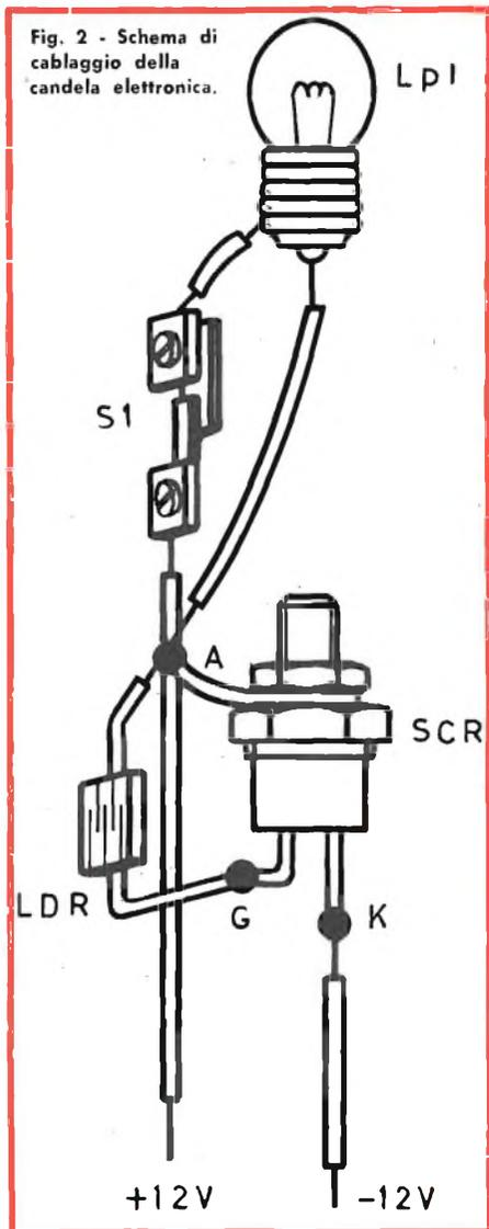
Fig. 2 - Schema di cablaggio della candela elettronica.
