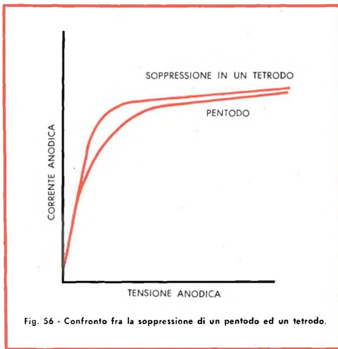
La zona nella quale gli elettroni vengono rallentati e respinti viene chiamata CATODO VIRTUALE. Se la tensione anodica viene portata più in alto dello zero il catodo virtuale e l'anodo agiscono pressochè come un diodo, con la corrente che viene prelevata dal catodo virtuale.
