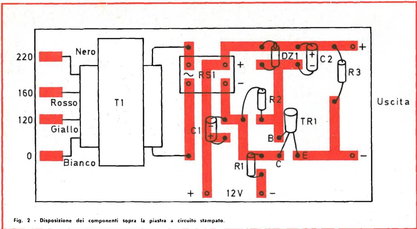
Fig. 2 - Disposizione dei componenti sopra la piastra a circuito stampato.
