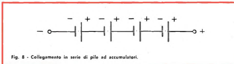
Fig. 8 - Collegamento in serie di pile ed accumulatori.
