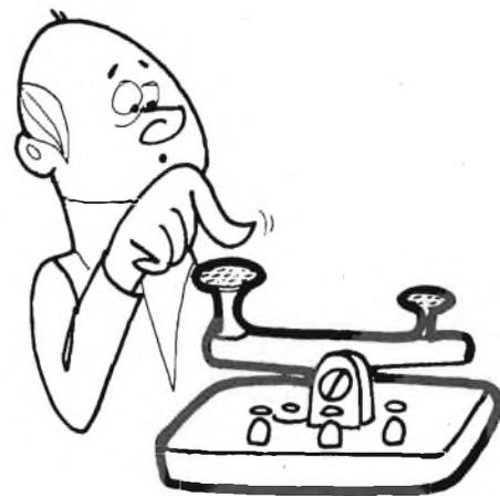
Fig. 10 - Per trasmettere a mano un messaggio codificato, Morse realizzò un manipolatore che chiudeva o apriva il circuito di trasmissione costituito da una linea, durante periodi di tempo più o meno lunghi a seconda che si trattava di una linea o di un punto. Un operatore bene addestrato poteva facilmente trasmettere da 900 a 1.200 parole all'ora.
