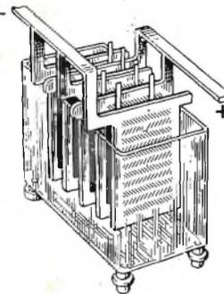
Fig. 6 - Disposizione della piastra di un accumulatore. Le piastre negative sono sempre due di più di quelle positive.
