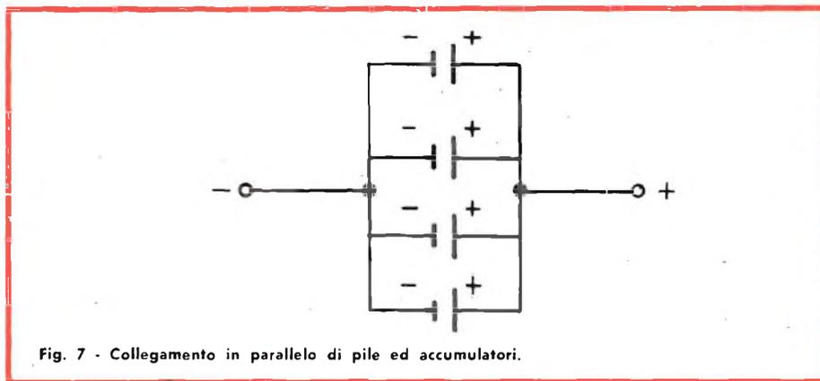
Fig. 7 - Collegamento in parallelo di pile ed accumulatori.
