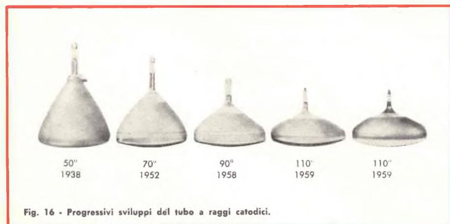
Fig. 16 - Progressivi sviluppi del tubo a raggi catodici.
