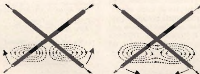
Fig. 7 - Azioni elettrodinamiche fra correnti incrociate.
