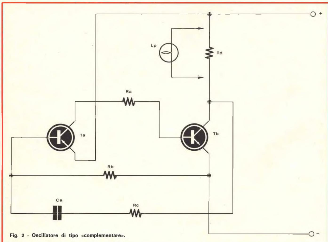
Fig. 2 - Oscillatore di tipo «complementare».
