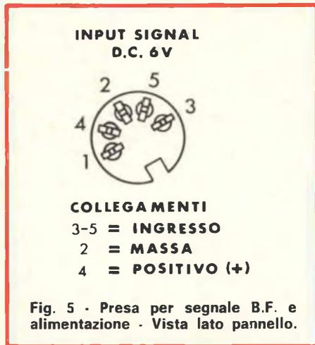
Fig. 5 - Presa per segnale B.F. e alimentazione - Vista lato pannello.
