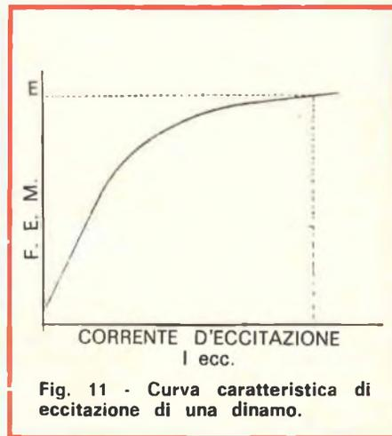
Fig. 11 - Curva caratteristica di eccitazione di una dinamo.
