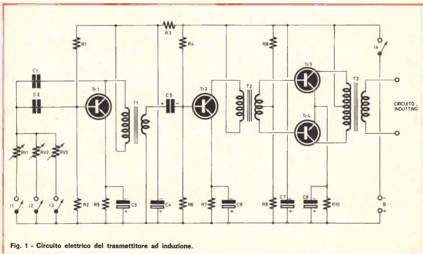
Fig. 1 - Circuito elettrico del trasmettitore ad induzione.
