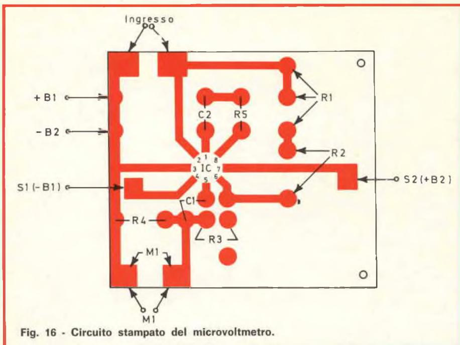
Effettuando la calibrazione di R1 mediante una sorgente campione di tensioni molto basse, il nostro dispositivo può rappresentare un nucleo molto interessante per l'elaborazione di un voltmetro elettronico multiscala. Così com'è, il circuito si presenta utile per lo studio delle correnti e delle tensioni basse: ad esempio per verificare e paragonare fenomeni elettrochimici, o per lavorare nel campo della bioelettronica; tralasciamo altri esempi ovvi.
