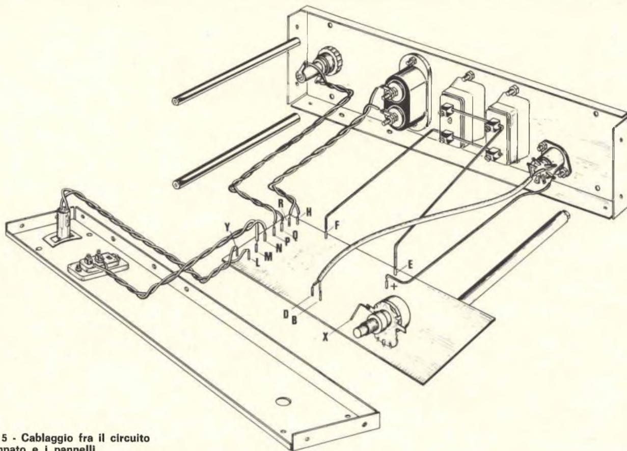
Fig. 5 - Cablaggio fra il circuito stampato e i pannelli.
