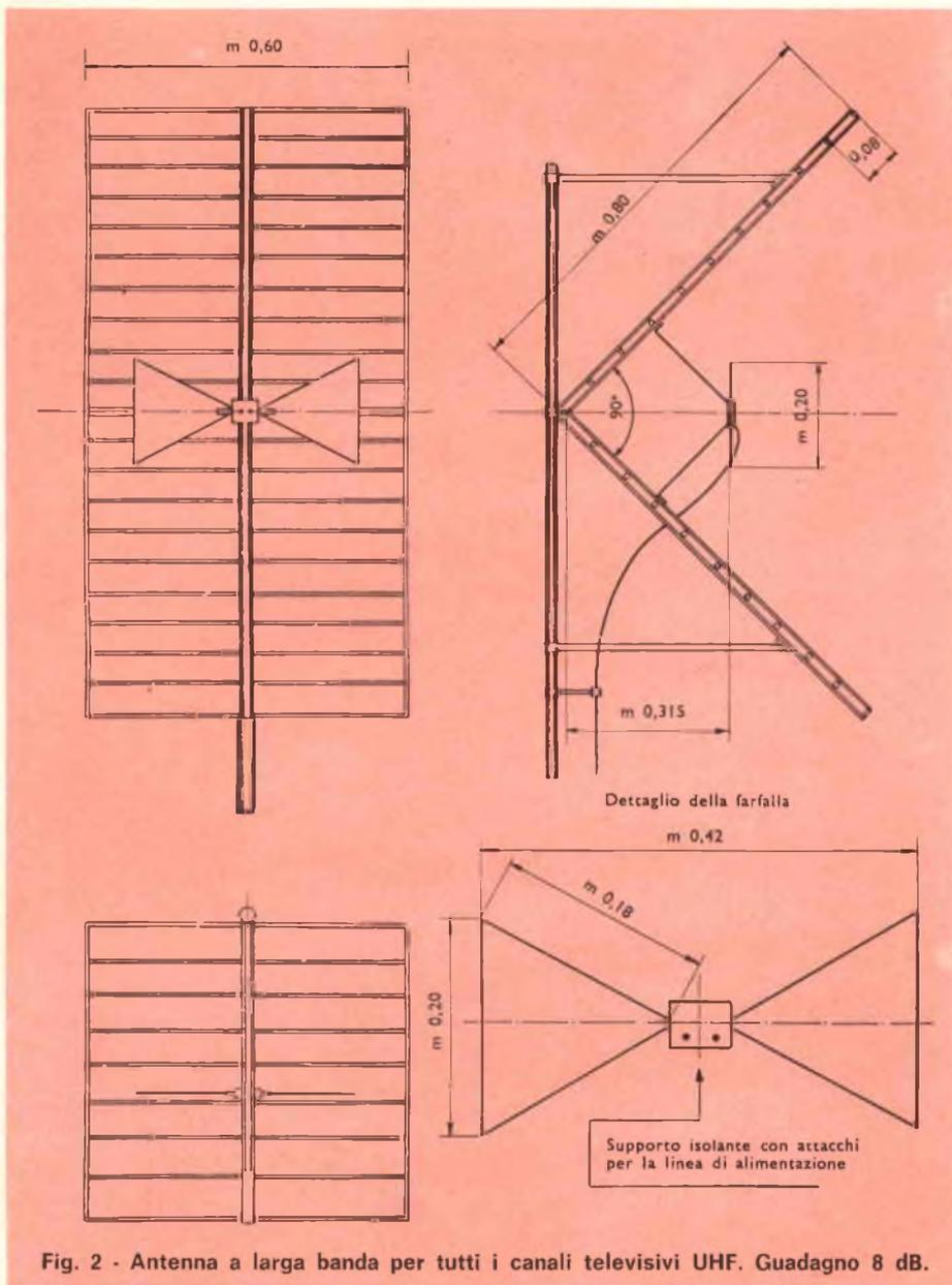
Fig. 2 - Antenna a larga banda per tutti i canali televisivi UHF. Guadagno 8 dB.
