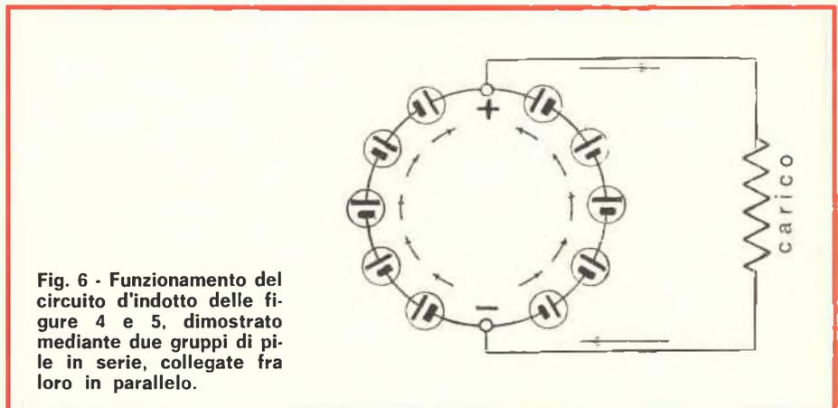
Fig. 6 - Funzionamento del circuito d'indotto delle figure 4 e 5, dimostrato mediante due gruppi di pile in serie, collegate fra loro in parallelo.
