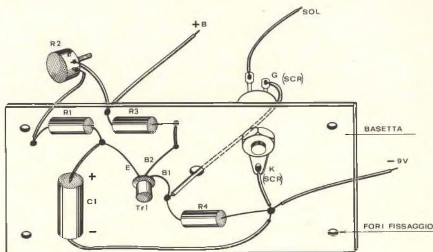
Fig. 4 - Cablaggio della basetta.
