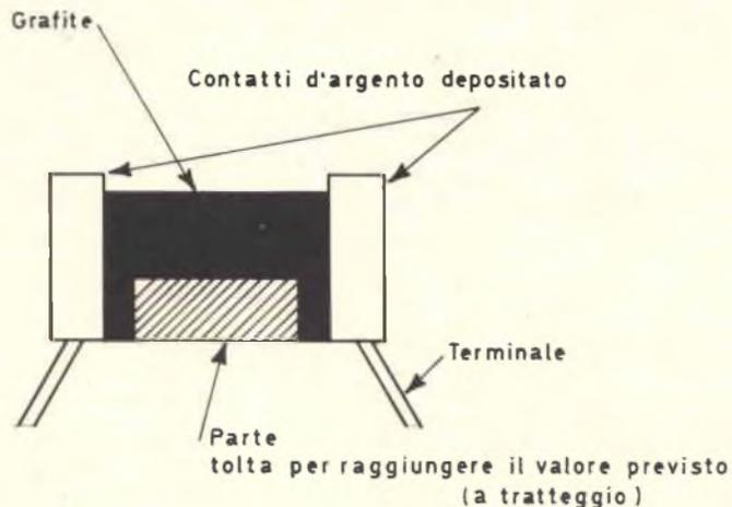
Fig. 12 - Rettifica di una resistenza «integrata»
