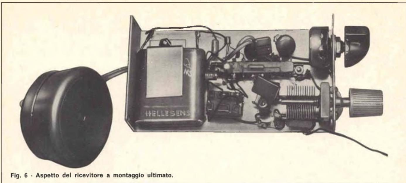
Fig. 6 - Aspetto del ricevitore a montaggio ultimato.
