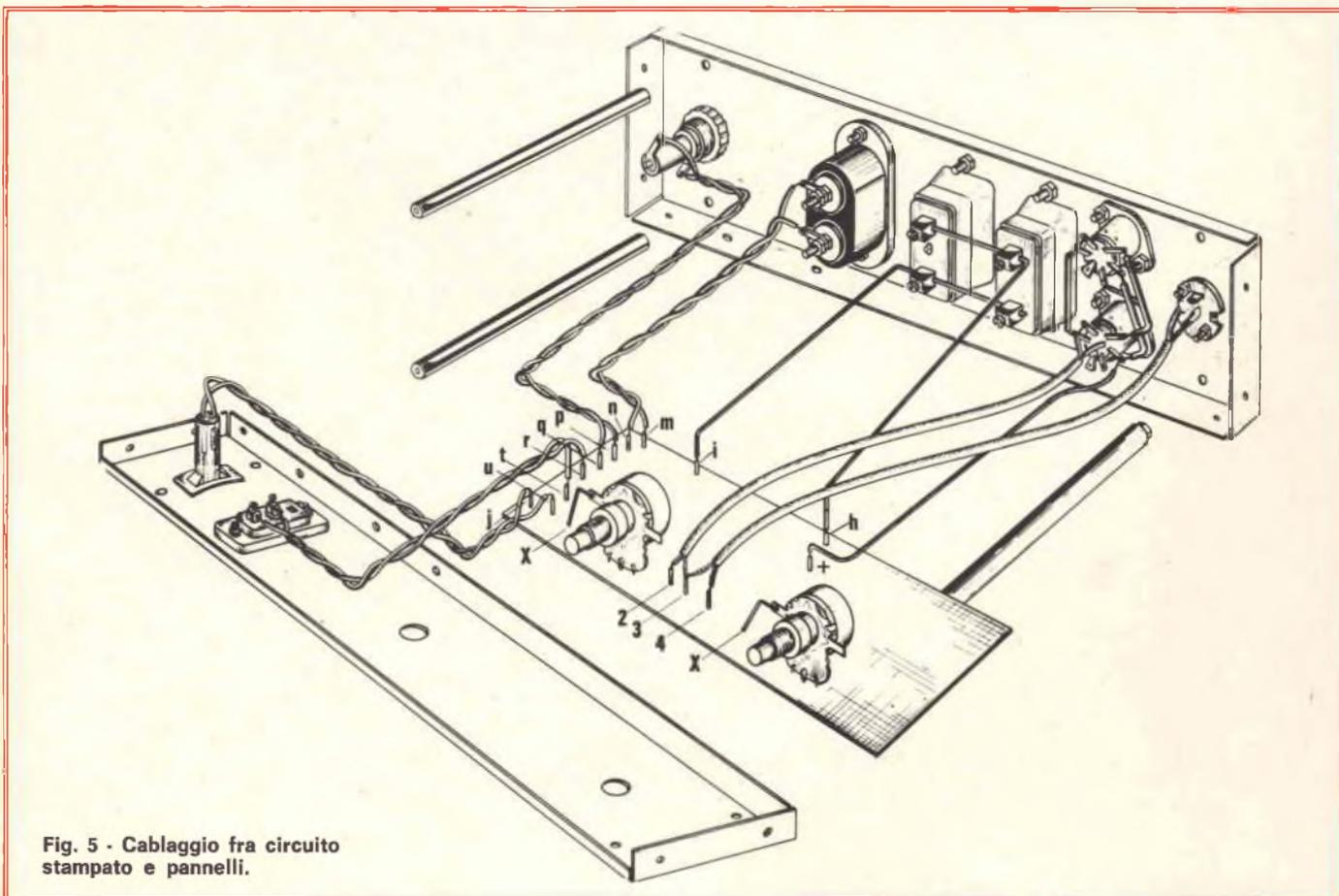
Fig. 5 - Cablaggio fra circuito stampato e pannelli.
