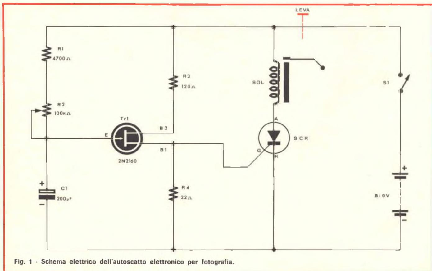
Fig. 1 - Schema elettrico dell'autoscatto elettronico per fotografia.
