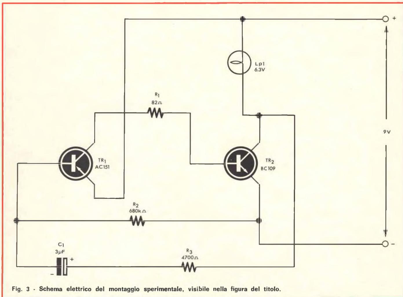
Fig. 3 - Schema elettrico del montaggio sperimentale, visibile nella figura del titolo.
