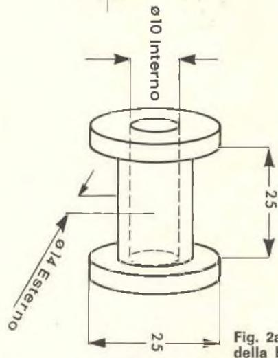
Fig. 2 - Dati costruttivi del solenoide.
