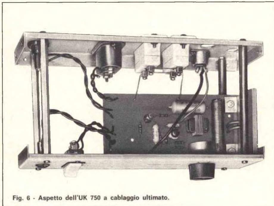
Fig. 6 - Aspetto dell'UK 750 a cablaggio ultimato.
