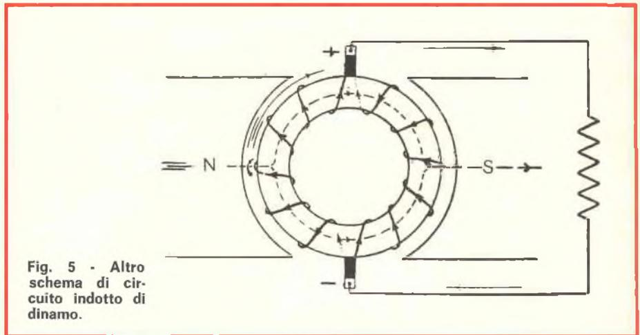
Fig. 5 - Altro schema di circuito indotto di dinamo.
