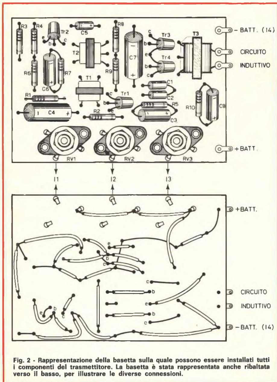
Fig. 2 - Rappresentazione della basetta sulla quale possono essere installati tutti i componenti del trasmettitore. La basetta è stata rappresentata anche ribaltata verso il basso, per illustrare le diverse connessioni.
