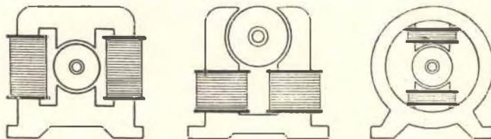
Fig. 1 - Alcune dinamo del tipo con induttore bipolare.
