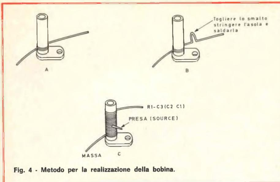
Fig. 4 - Metodo per la realizzazione della bobina.
