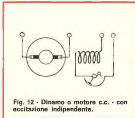
Fig. 12 - Dinamo o motore c.c. con eccitazione indipendente.
