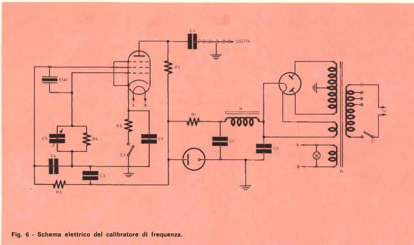
Fig. 6 - Schema elettrico del calibratore di frequenza.
