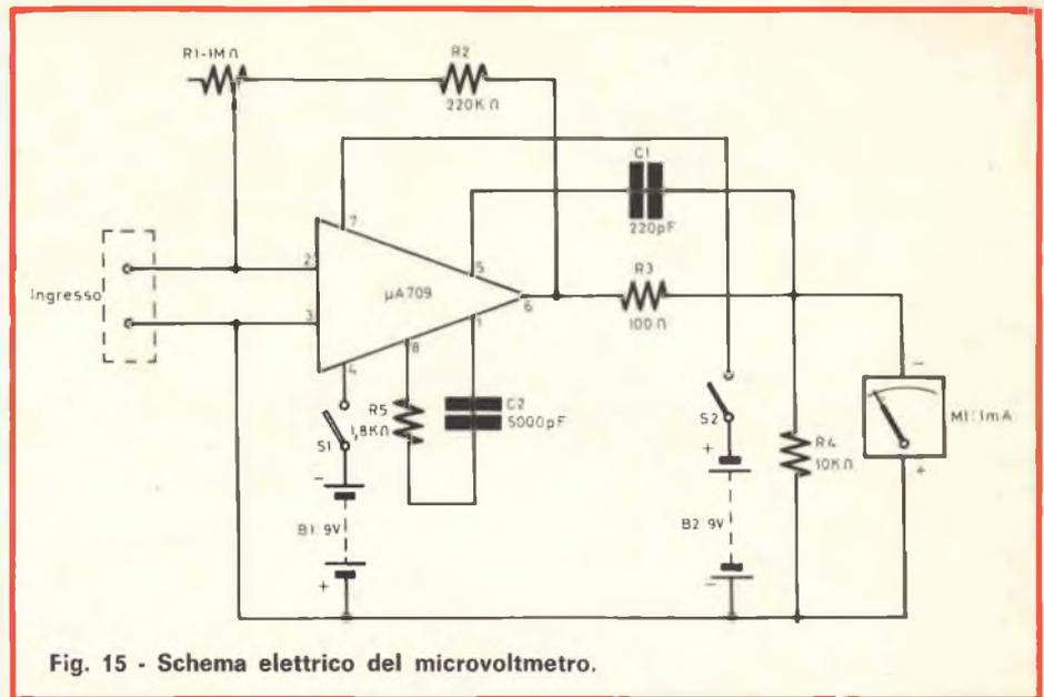
Fig. 15 - Schema elettrico del microvoltmetro.
