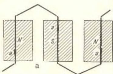
Fig. 10 - a = collegamento dei conduttori d'indotto in parallelo, b = collegamento in serie.
