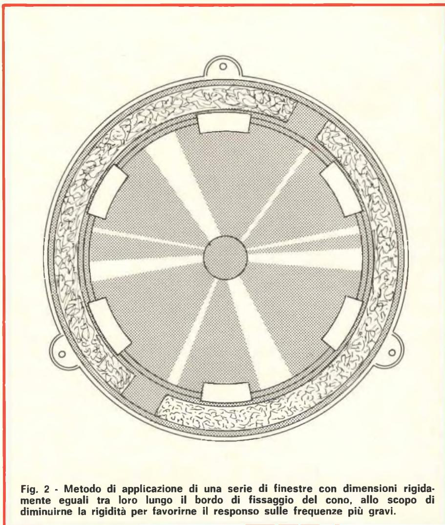
Fig. 2 - Metodo di applicazione di una serie di finestre con dimensioni rigidamente eguali tra loro lungo il bordo di fissaggio del cono, allo scopo di diminuirne la rigidità per favorirne il responso sulle frequenze più gravi.
