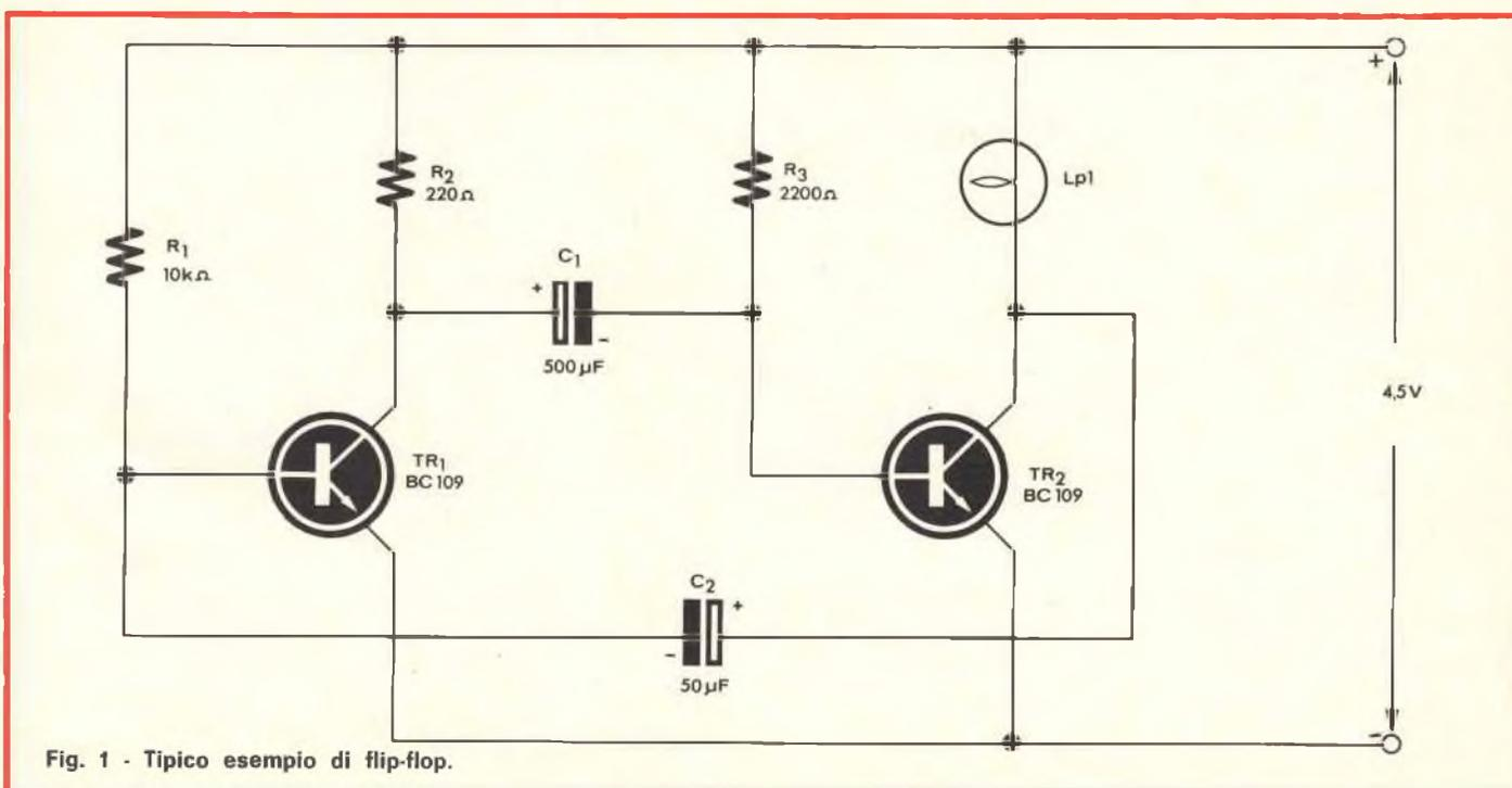
Fig. 1 - Tipico esempio di flip-flop.
