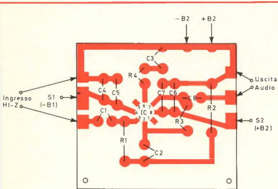
Fig. 12 - Circuito stampato del preamplificatore HI-FI.
