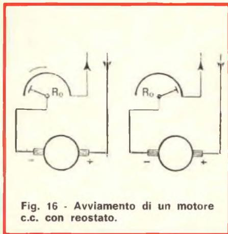
Fig. 16 - Avviamento di un motore c.c. con reostato.
