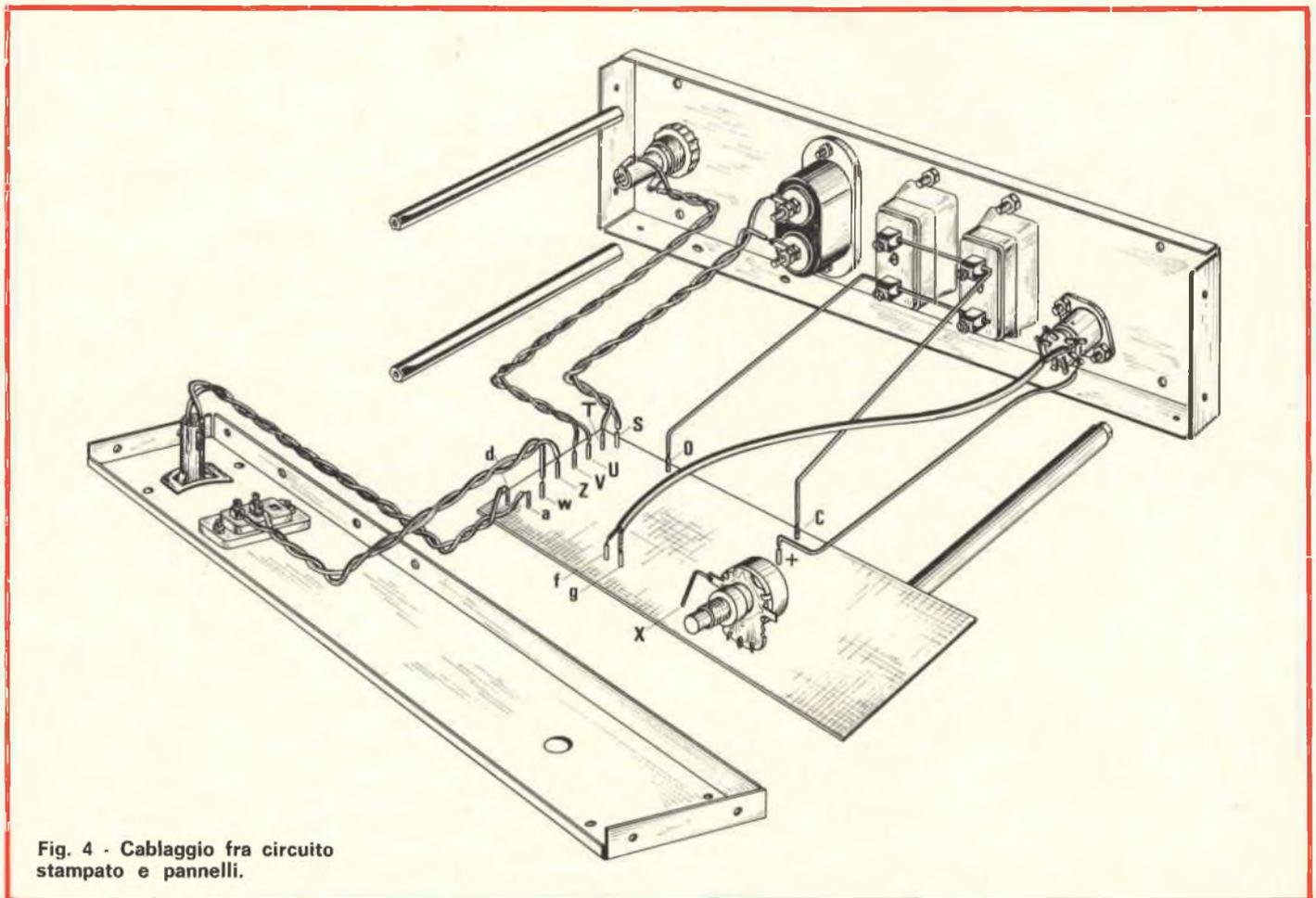
Fig. 4 - Cablaggio fra circuito stampato e pannelli.
