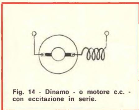
Fig. 14 - Dinamo - o motore c.c. - con eccitazione in serie.
