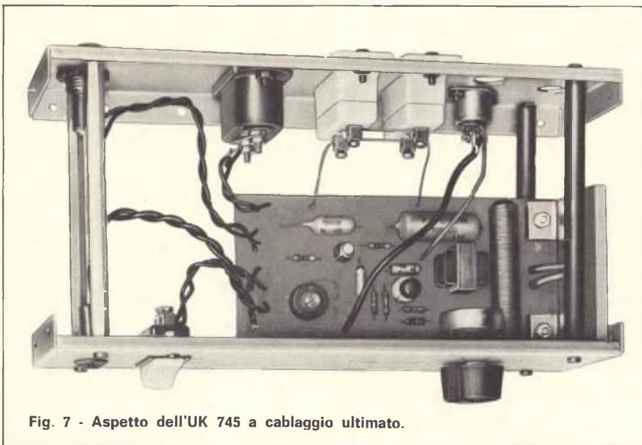
Fig. 7 - Aspetto dell'UK 745 a cablaggio ultimato.
