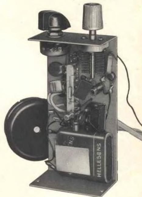
Il circuito Source (S) - Gate (G) del TR1 demodula i segnali, che sono privati della componente RF spuria da C3-JAF1-C4.
