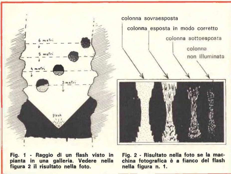
Fig. 1 - Raggio di un flash visto in pianta in una galleria. Vedere nella figura 2 il risultato nella foto.
