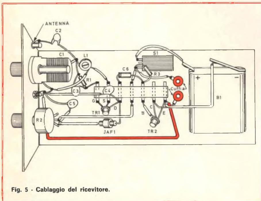
Fig. 5 - Cablaggio del ricevitore.
