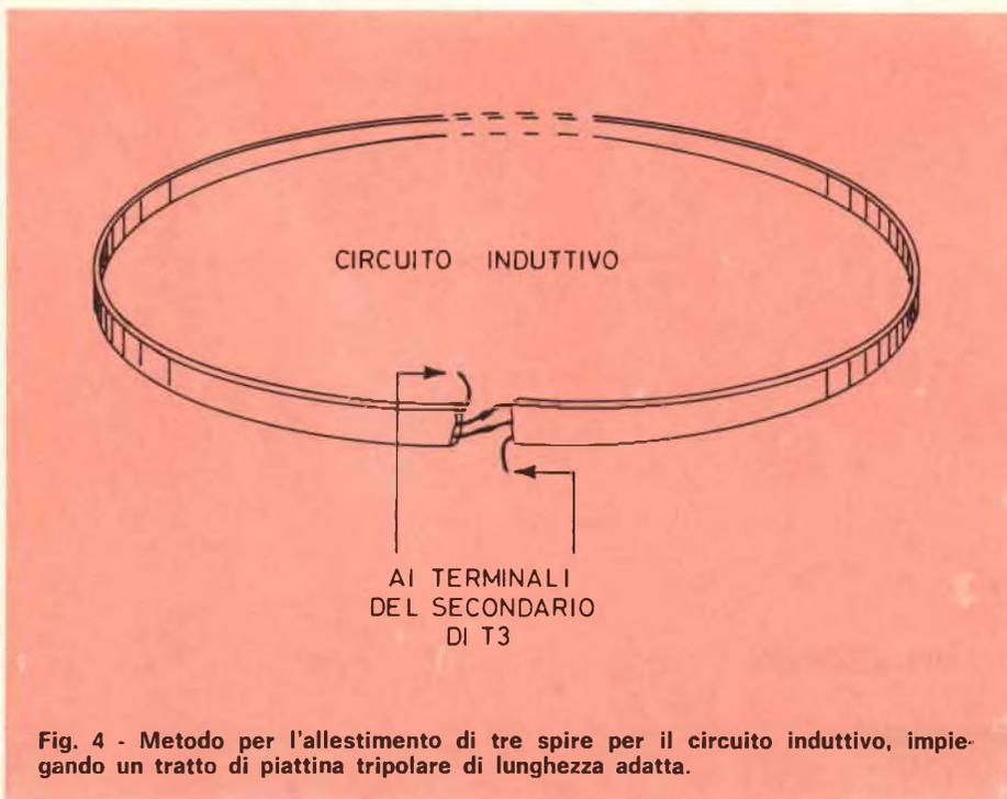
Fig. 4 - Metodo per l'allestimento di tre spire per il circuito induttivo, impiegando un tratto di piattina tripolare di lunghezza adatta.
