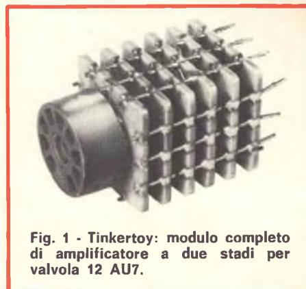
**Fig. 1 - Tinkertoy: modulo completo di amplificatore a due stadi per valvola 12 AU7.**
