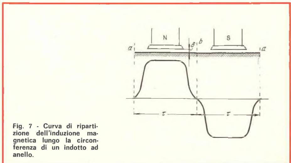
Fig. 7 - Curva di ripartizione dell'induzione magnetica lungo la circonferenza di un indotto ad anello.
