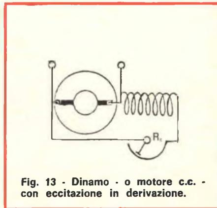
Fig. 13 - Dinamo o motore c.c. con eccitazione in derivazione.
