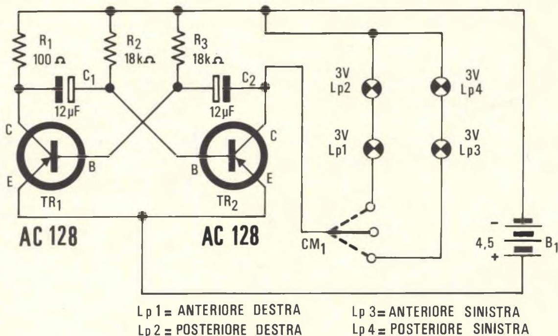
Fig. 1 - Schema elettrico dell'indicatore di direzione.
