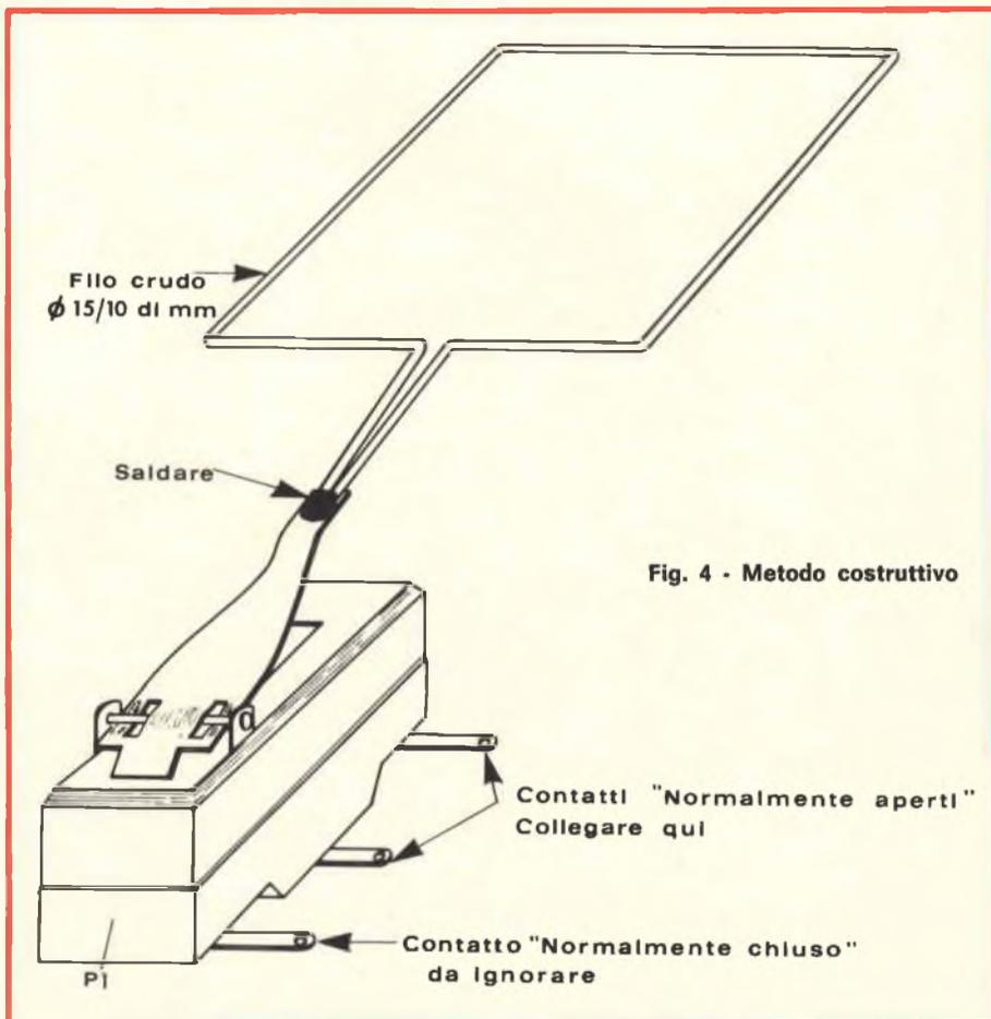
Fig. 4 - Metodo costruttivo
