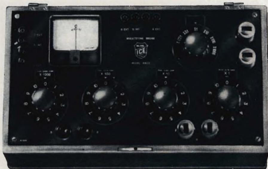
Fig. 3 - Ponte di Wheatstone di elevata precisione per la misura di resistori da 0,01  $\Omega$  fino a 10 M $\Omega$ .
