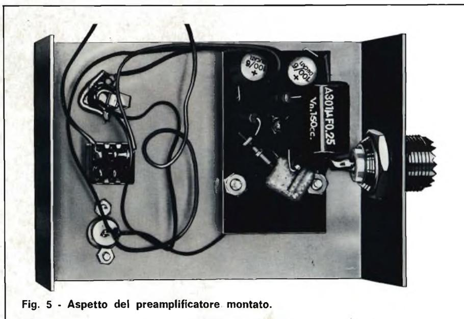
Fig. 5 - Aspetto del preamplificatore montato.
