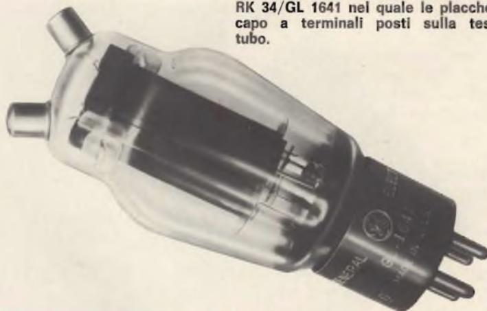
Fig. 5 - Un classico rettificatore AT ad alto vuoto: si tratta del famoso modello RK 34/GL 1641 nel quale le placche fanno capo a terminali posti sulla testa del tubo.
