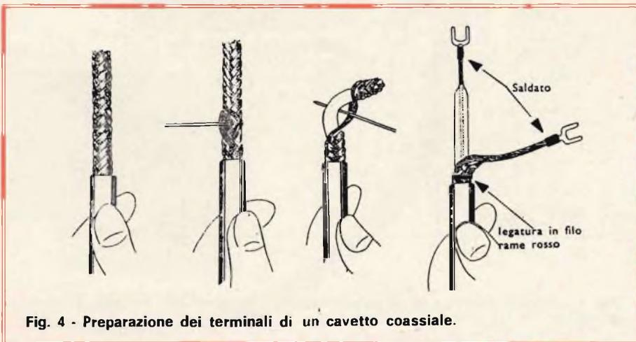
Fig. 4 - Preparazione dei terminali di un cavetto coassiale.
