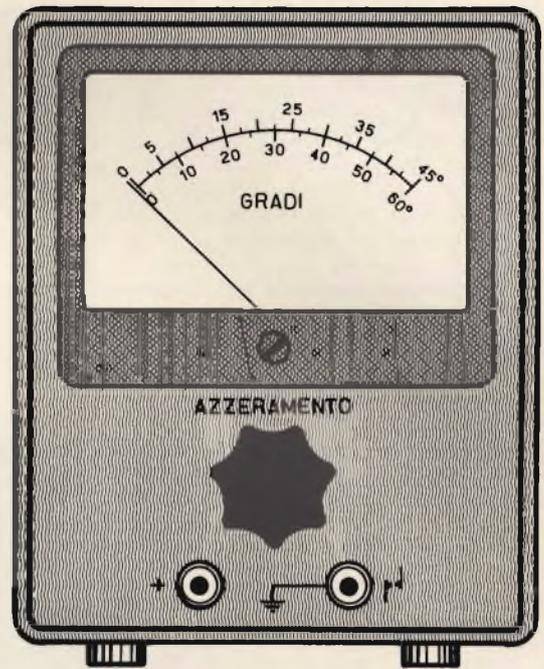
**Fig. 2** - Aspetto che è possibile conferire all'apparecchiatura, installandola in un involucro metallico di tipo convenzionale. Sul pannello frontale sono visibili lo strumento propriamente detto, la manopola per l'azzeramento, e le due boccole alle quali fanno capo i cavetti di prova che vanno collegati all'impianto di accensione.
