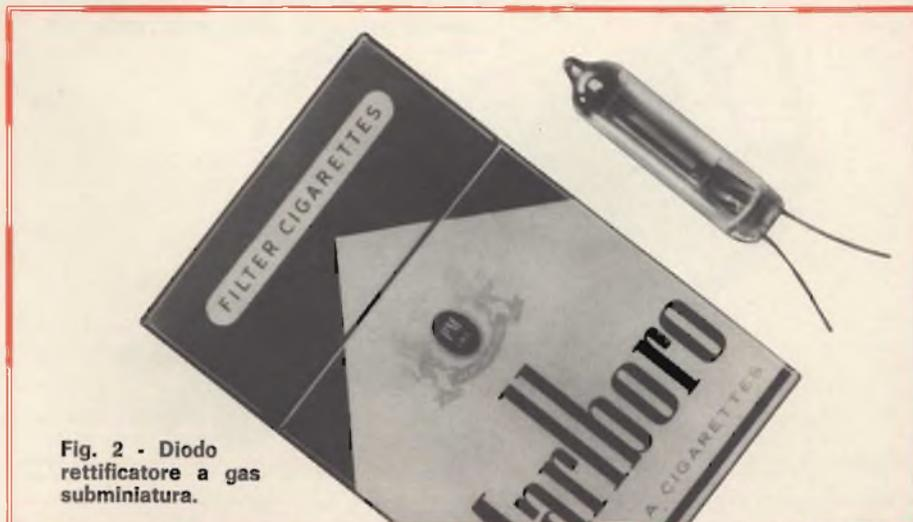
Fig. 2 - Diodo rettificatore a gas subminiatura.
